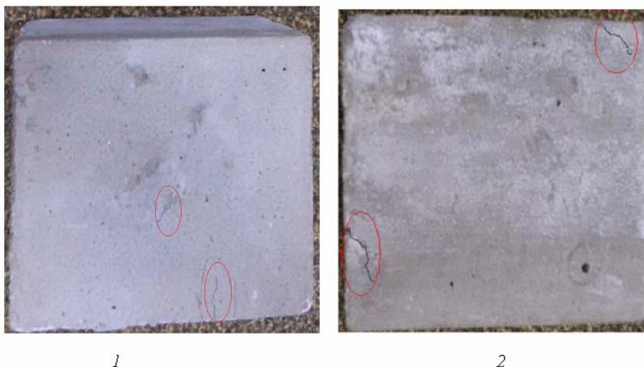
Рис. 2. Образцы плиточного клея после проведения испытаний
