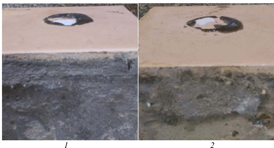
Рис. 3. Образцы после проведения испытания: 1 – оттаивание в воздушной среде; 2 – оттаивание во влажной среде
