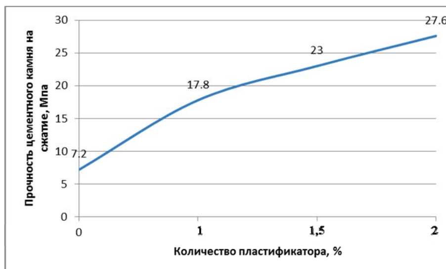
Рис. 5. Влияние количества гиперпластификатора на прочность при сжатии цементного камня (количество волокон Rapasea 12 мм 1 % от массы цемента)
