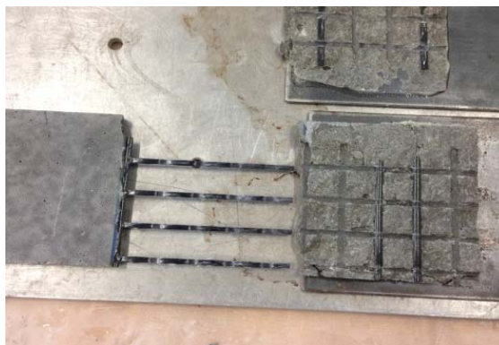
Рис. 5. Внешний вид образцов после испытаний на разрыв
