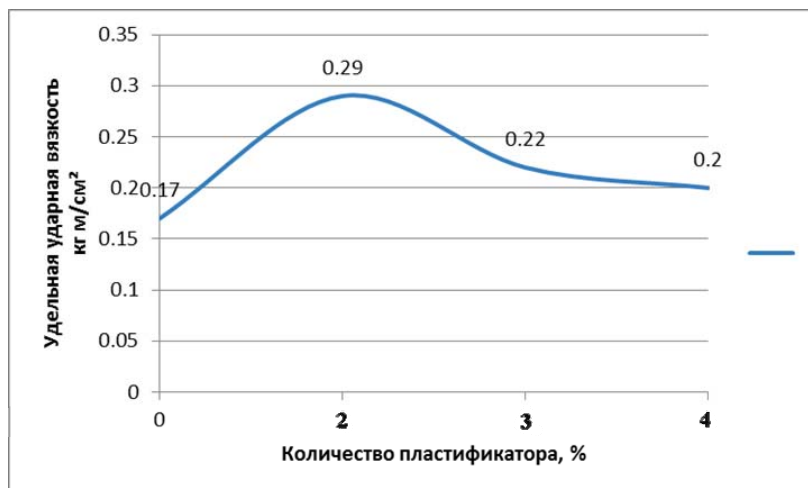
Рис. 6. Влияние количества гиперпластификатора на удельную ударную вязкость цементного камня (количество волокон Rapasea 12 мм 1 % от массы цемента)
