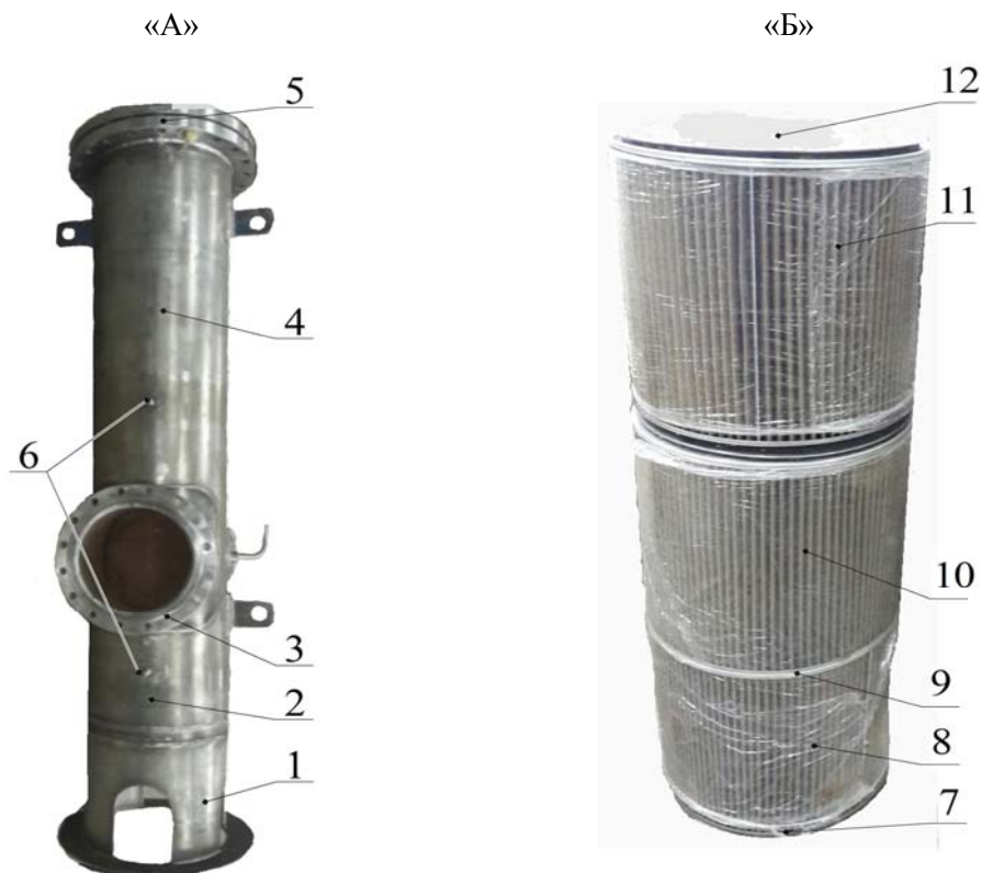
Рис. 2. А – общий вид цилиндрического фильтра оптимальной формы, выпускаемого АО «Гипрониигаз», с диаметром входного и выходного патрубков 350 мм и размещенным внутри него блоком из трех опорных оболочек ЦФУ; Б – общий вид трех ЦФУ из сетки, установленных последовательно на одной оси, конструкции АО «Гипрониигаз»: 1 – опора фильтра; 2 – нижняя часть корпуса фильтра для сбора твердых частиц; 3 – выходной патрубок с фланцем; 4 – верхняя часть корпуса с размещенными внутри него тремя ЦФУ из сетки один на другом; 5 – фланец и крышка корпуса; 6 – штуцера для присоединения датчиков предельного перепада давления до и после ЦФУ; 7 – кольцеобразная нижняя пластина каждого из фильтрующих гофрированных устройств 8, 10, 11, выполняющая функцию поперечного ребра жесткости; 8, 10, 11 – соответственно нижнее, среднее и верхнее фильтрующие устройства, каждое из которых имеет в своем составе опорные оболочки; 9 – кольцеобразная верхняя пластина каждого из фильтрующих устройств 8, 10, 11, выполняющая функцию поперечного ребра жесткости; 12 – крышка.
