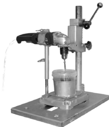
Рис. 1. Лабораторный аппарат, предназначенный для воздействия на воду затворения и растворные смеси в лабораторных условиях при приготовлении образцов для испытаний
