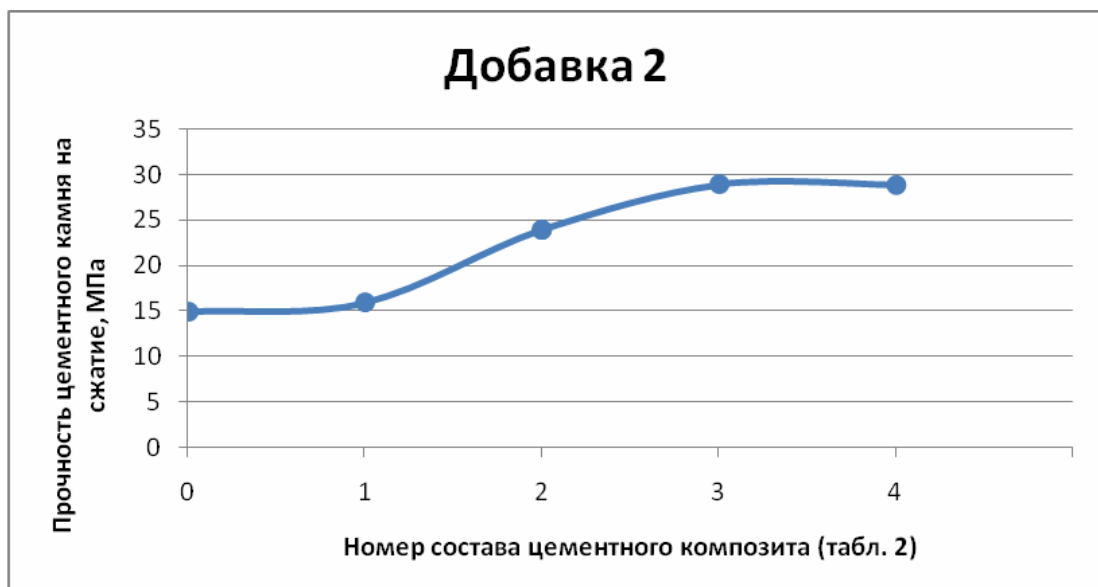
Рис. 3. Влияние тонкодисперсной добавки (кальцийсодержащая добавка) и волокон на прочность цементного камня
