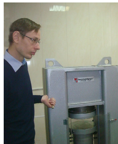
Директор технопарка «Интеллект» А.П. Самошин у пресса ИП-1А-500 АБ ПК Универсал, позволяющего испытывать образцы строительных материалов согласно ГОСТ 12801-98.
