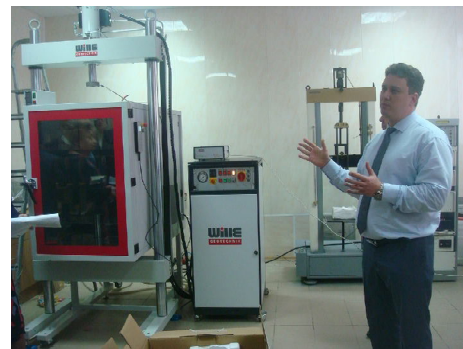
Декан технологического факультета Р.В. Тарасов демонстрирует уникальную автоматизированную систему WILLE Geotechnik для исследования параметров ползучести, усталостных напряжений и прочности асфальтобетона под действием динамических нагрузок.
