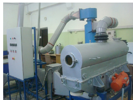
Участок сушки макета технологической линии по изготовлению добавок для асфальтобетона.
