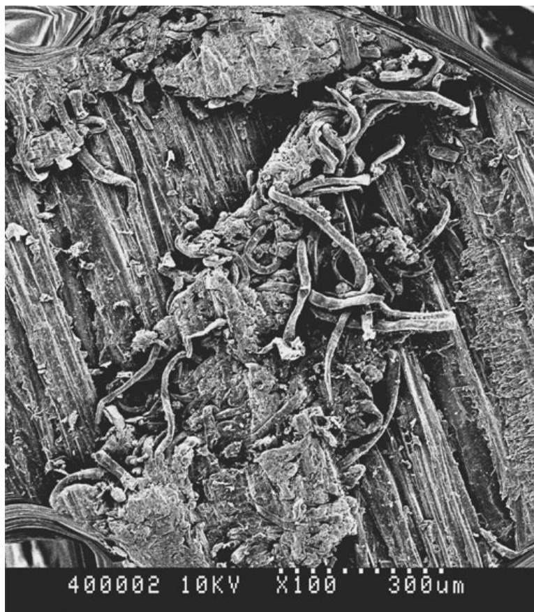
Рис. 29. Микрофотографии структур целлюлоза-лигнин, сделанные с помощью электронного микроскопа
