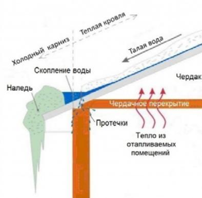
Рис. 6. Схема образования протечек на карнизных участках скатных крыш
