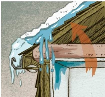
Схема образования зимних протечек
