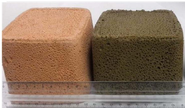
Рис. 4. Образцы ячеистого материала из природных силицитов: сырец (справа) и керамика (слева)
