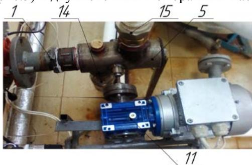
Рис.3. Импульсный распределитель потока теплоносителя с электроприводом
