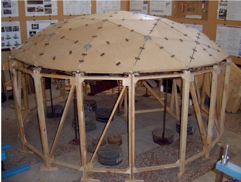
Рис. 2. Экспериментальная купольная конструкция
