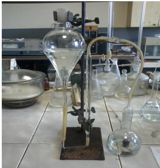
Рис.2. Общий вид лабораторной установки для определения концентрации феррата натрия в активированном растворе гидроксида натрия
