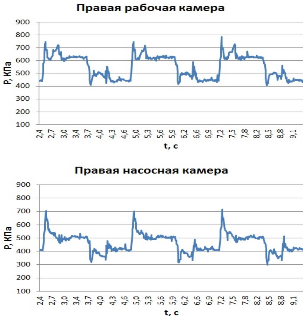
Рис. 5. Зависимость давления при частоте 0,4 Гц
