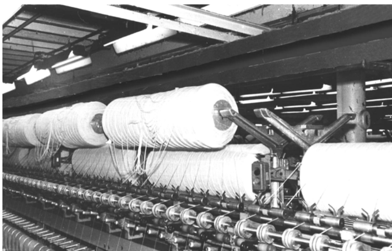
Рис. 7. Установка воздухораспределителя на раме прядильной машины в зоне ровницы: 1 – прядильная машина; 2 – воздухораспределитель; 3 – обрабатываемая бобина с ровницей; 4 – запасные бобины с ровницей
