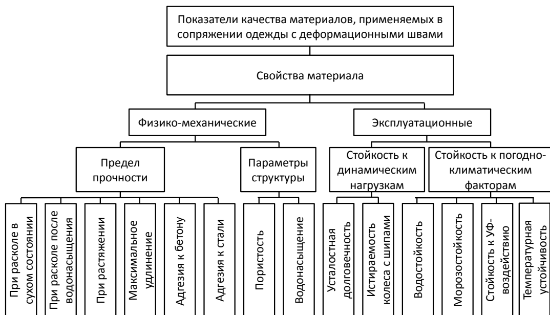
Рис. 2. Декомпозиция системы качества материалов, применяемых в сопряжении дорожной одежды с деформационными швами
