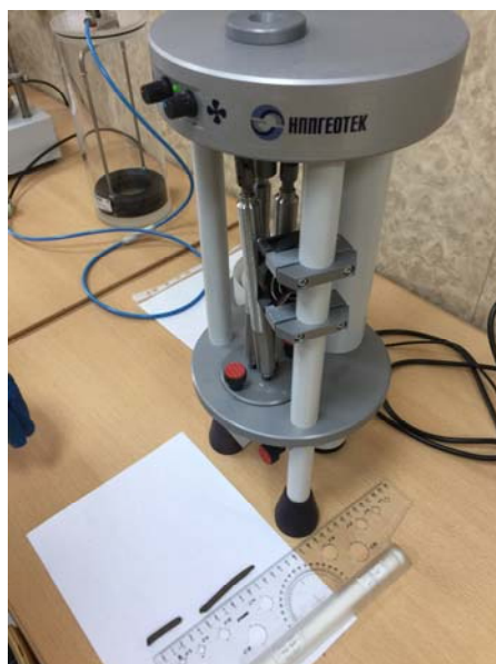
Рис. 2. Испытание грунта методом раскатывания
