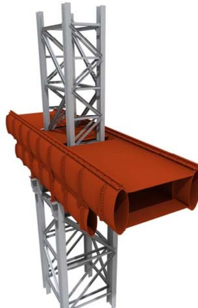
Рис. 3. Модель подкрановой балки
