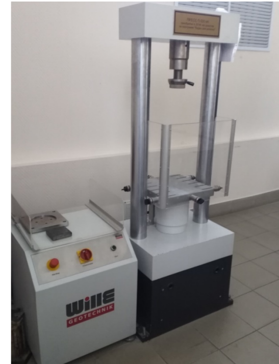
Рис. 3. Испытательный пресс ПТС-500
