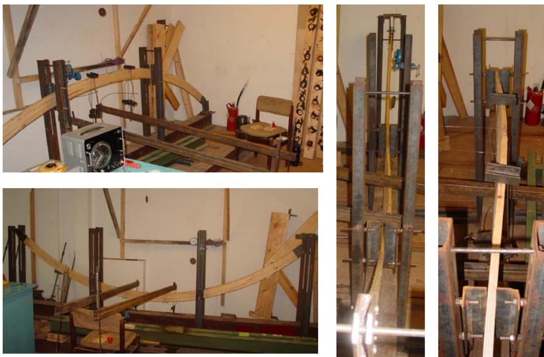
Рис. 5. Виды испытаний (слева) и виды элементов после потери устойчивости (справа)
