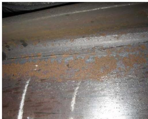
Рис. 9. Усталостная трещина в балке №1
