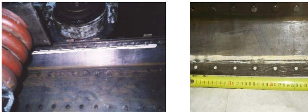
Рис. 17. Усталостная трещина в составной балке в подрельсовой зоне
