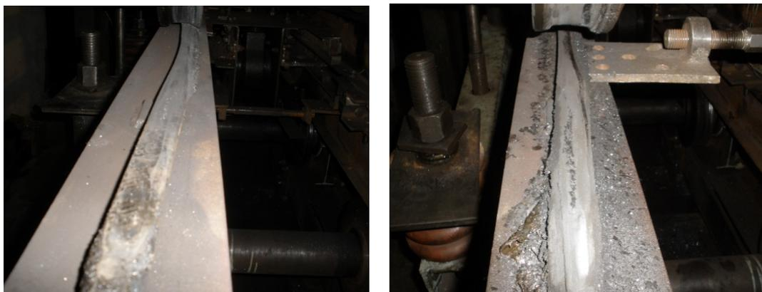
Рис. 4. Износ рельсов и талреп
