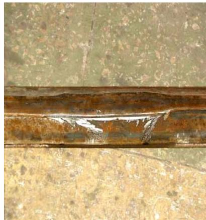
Рис. 16. Износ рельса
