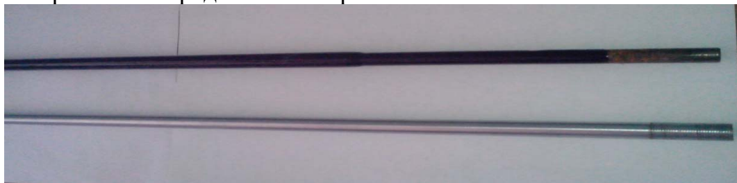
Рис. 3.4. Общий вид ротора покрытого стеклоэмалью и ротора с необработанной поверхностью
