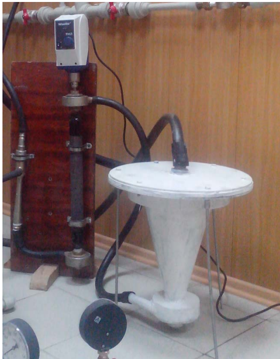
Рис. 4.2. Общий вид установки для экспериментальных исследований процесса разделения диспергированной водовоздушной смеси в поле действия центробежных сил
