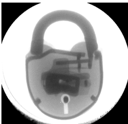
Рис. 1.26. Рентгенограмма замка, расположенного под стальной плитой
