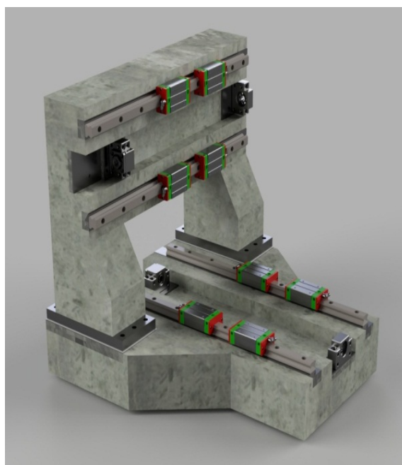
Рис. 5. Проект станины из железобетона металлообрабатывающего станка с ЧПУ
