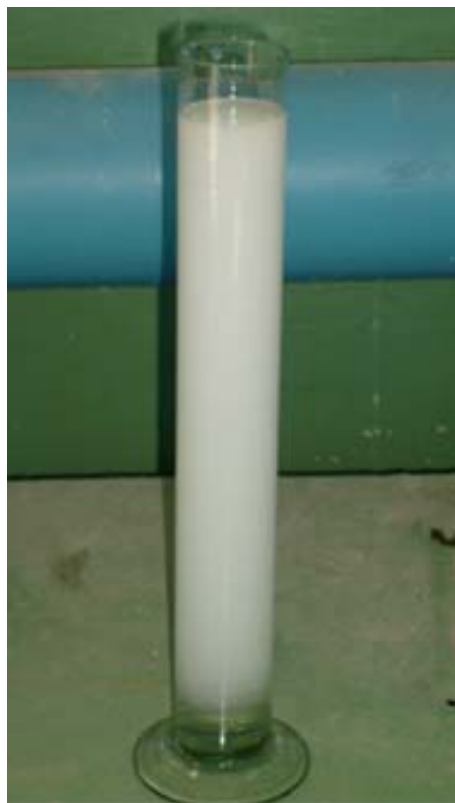
Рис. 5. Общий вид водовоздушной смеси, образованной в вихревом гидродинамическом аэраторе при величине давления на входе P_a=0,8 МПа
