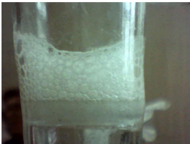
Рис. 6. Формы ячеек в пенах, стабилизированных гидрофобизованным людоксом (1 % людокс + 11 ммоль/л гексиламин, n_g = 1.1 ммоль/г)
