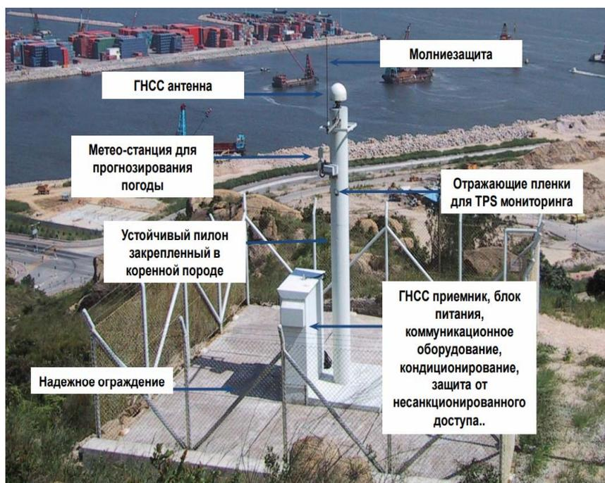
Рис. 1. Структура базовой станции для определения координат объектов строительства и границ земельных участков
