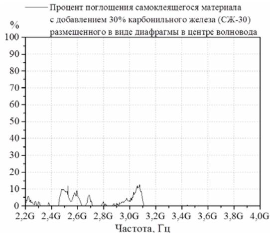
Рис. 19. Анализ процесса поглощения самоклеящегося материала с добавкой СЖ-30, мВт
