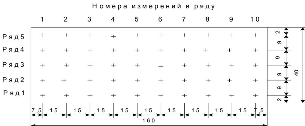
Рис. 1. Схема измерения шероховатости поверхности лакокрасочных покрытий на цементной подложке (все размеры даны в мм)
