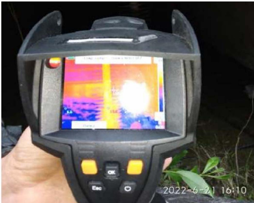
Рис. 8. К оценке работоспособности термостабилизаторов (тепловизионное обследование)
