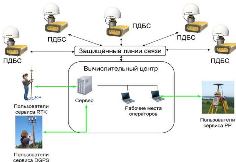
Рис. 4. Схема определения координат в режиме RTK относительно сети базовых станций
