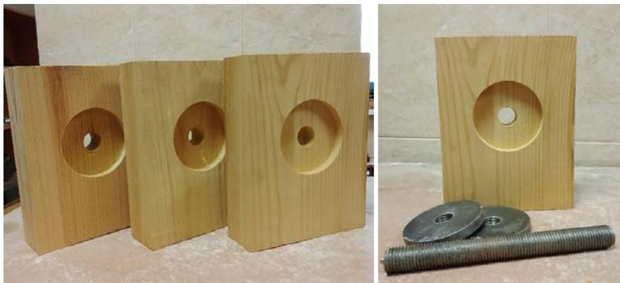
Рис. 1. Элементы испытываемых образцов
