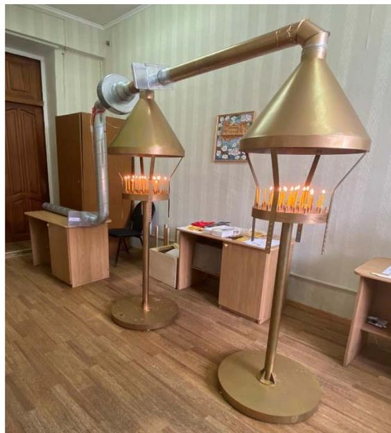
Рис. 9. Экспериментальный стенд системы местной вытяжной вентиляции с удалением загрязненного воздуха с помощью зонтов из верхней зоны:
