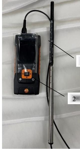
Рис. 2. Общий вид термоанемометра типа Testo 440:
