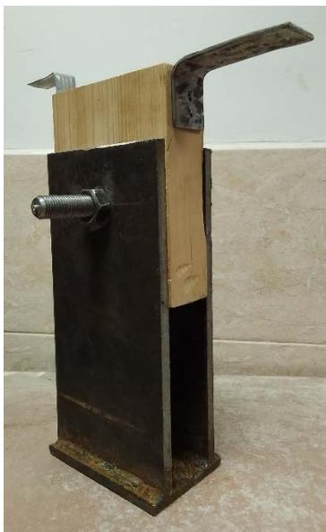
Рис. 2. Образец, готовый к испытанию
