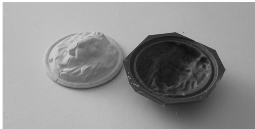
Рис. 2. Опалубка из пластика и отливка из гипса ГВВС-16
