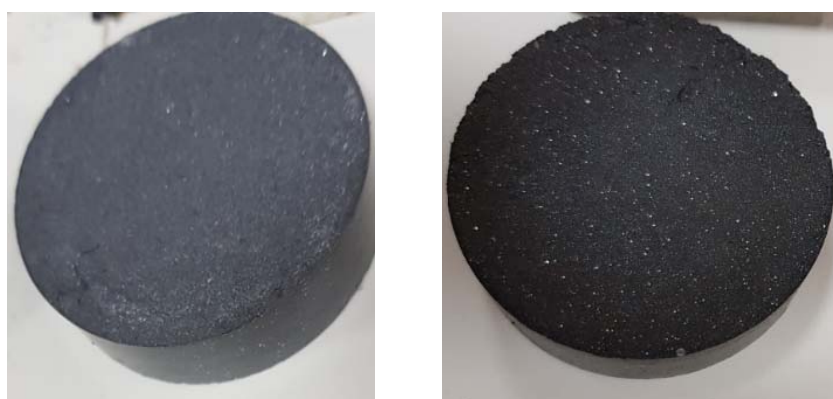
Фото 3. Образцы материала: без термической обработки (слева); после (справа)
