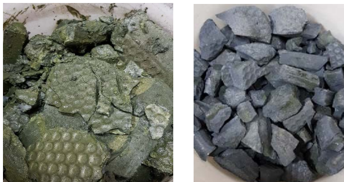
Фото 1. Образцы отходов после пресс-фильтра: до сушки (слева); после сушки (справа)
