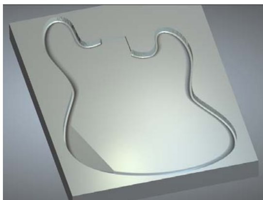
Рис. 3. Симуляция траектории чистовой обработки верхнего рельефа корпуса
