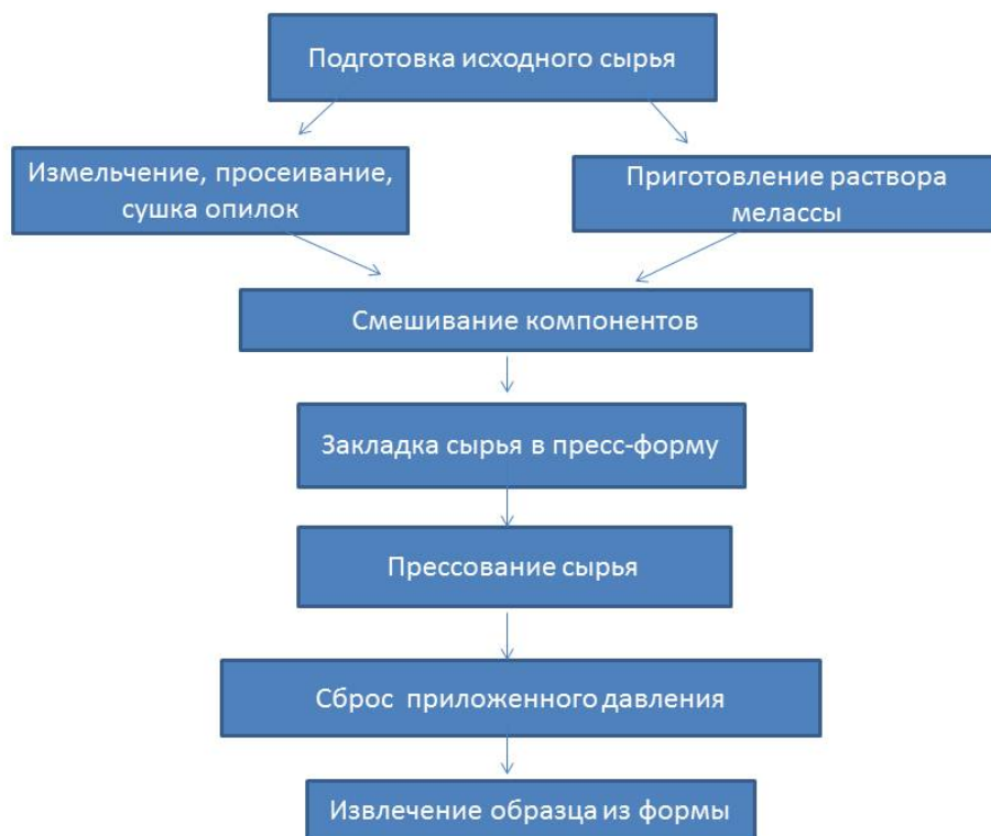
Рис. 1. Схема технологического процесса изготовления опытного образца биотоплива в лабораторных условиях
