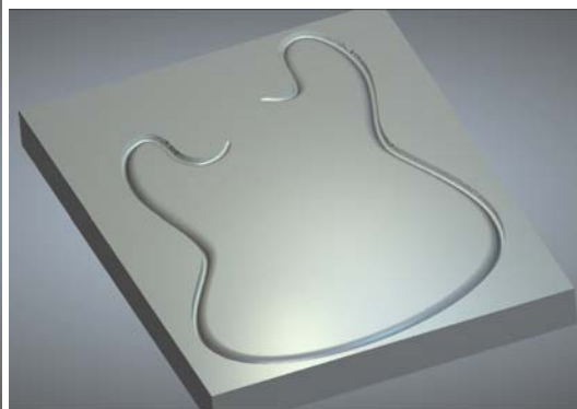
Рис. 4. Симуляция траектории чистовой обработки нижнего рельефа корпуса
