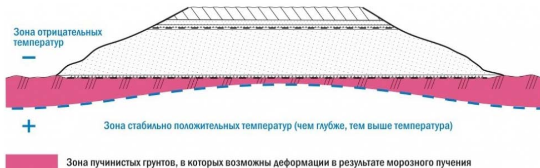
Рис. 1. Схема расположения насыпи на пучинистом грунте
