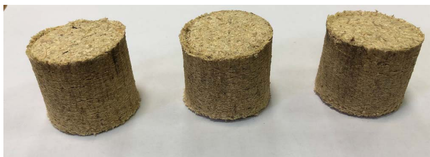
Фото 1. Брикеты, отпрессованные при удельном давлении 70 МПа
