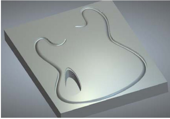
Рис. 6. Симуляция траекторий выборки нижней полости для электроники
