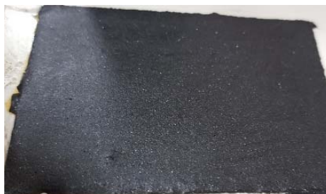
Фото 4. Образец эпоксидного защитного покрытия с наполнителем из дисперсных отходов обоевого производства
