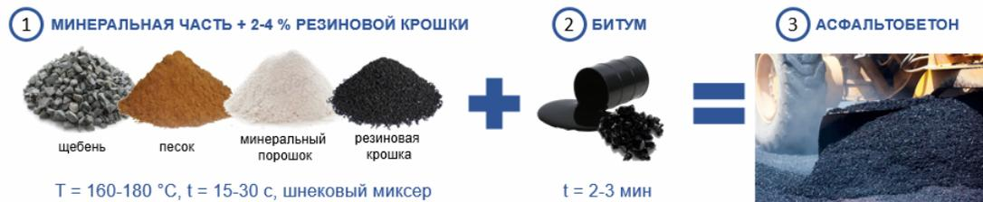
Рис. 1. Схематичное изображение сухого метода введения резиновой крошки в асфальтобетонную смесь
