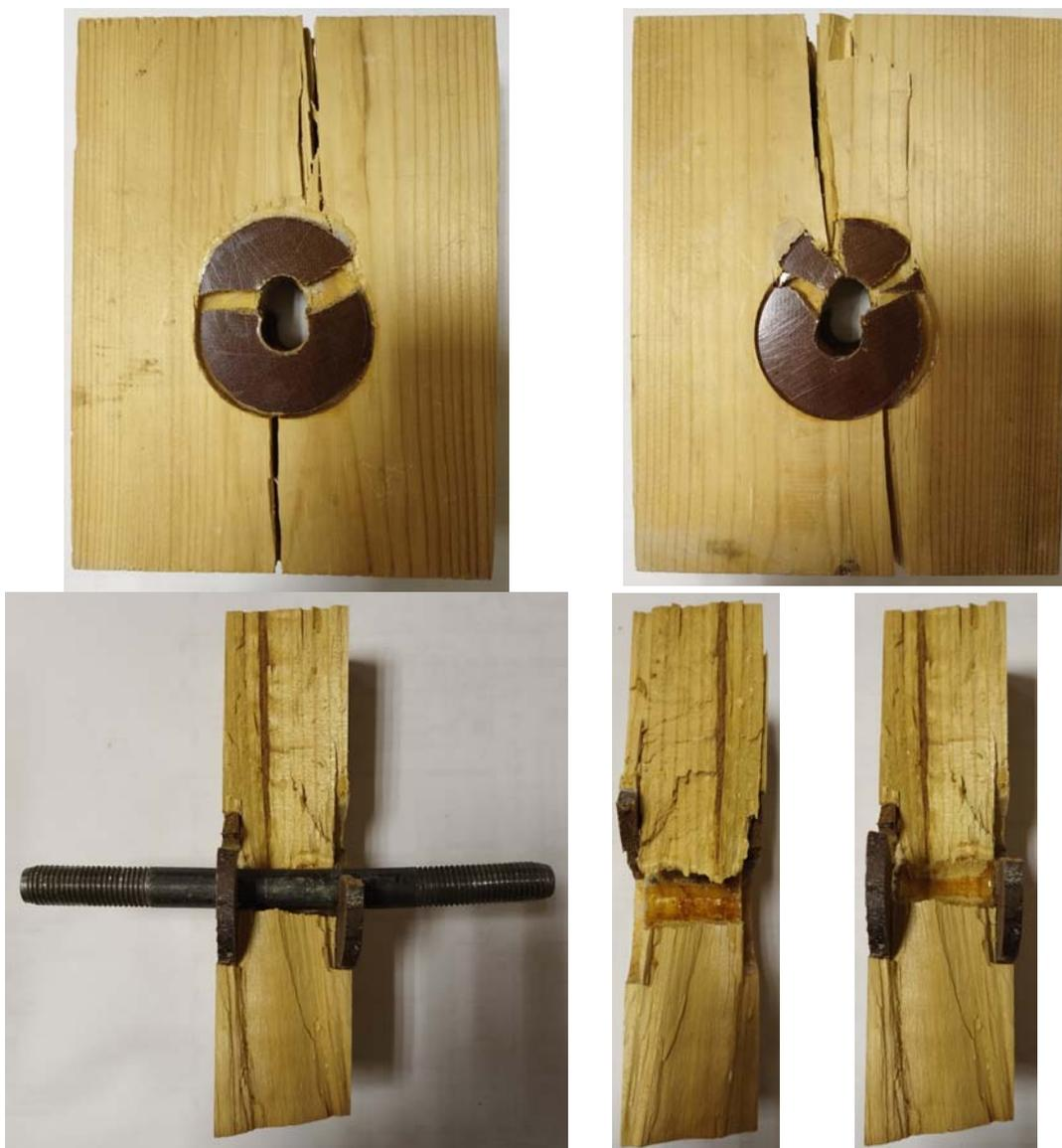
Рис. 5. Общий вид разрушения образцов
