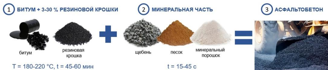
Рис. 2. Схематичное изображение мокрого метода введения резиновой крошки в асфальтобетонную смесь
