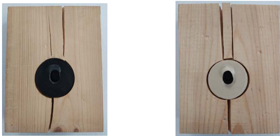
Рис. 5. Общий вид разрушения образцов
