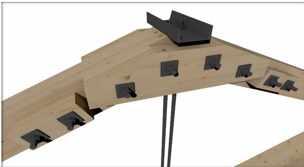
Рис. 5. Информационная модель конькового узла фермы
