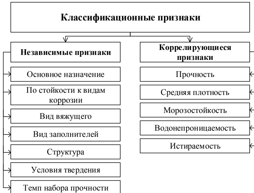
Рис. 3. Классификация признаков бетона
