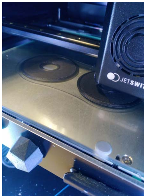
Рис. 1. Печать шайб на 3D-принтере Picaso Designer X PRO
