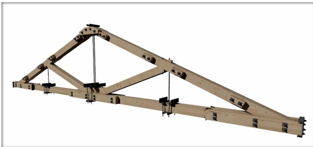
Рис. 4. Информационная модель стропильной фермы здания в Петрозаводске
