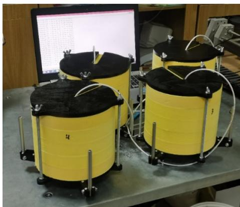
Рис. 8. Процесс исследования гидратации цемента с помощью модернизированного калориметра
