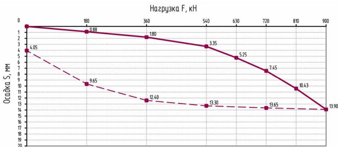
Рис. 6. График зависимости осадки сваи  $S$  (мм) от нагрузки  $F$  (кН) C110.30-11
