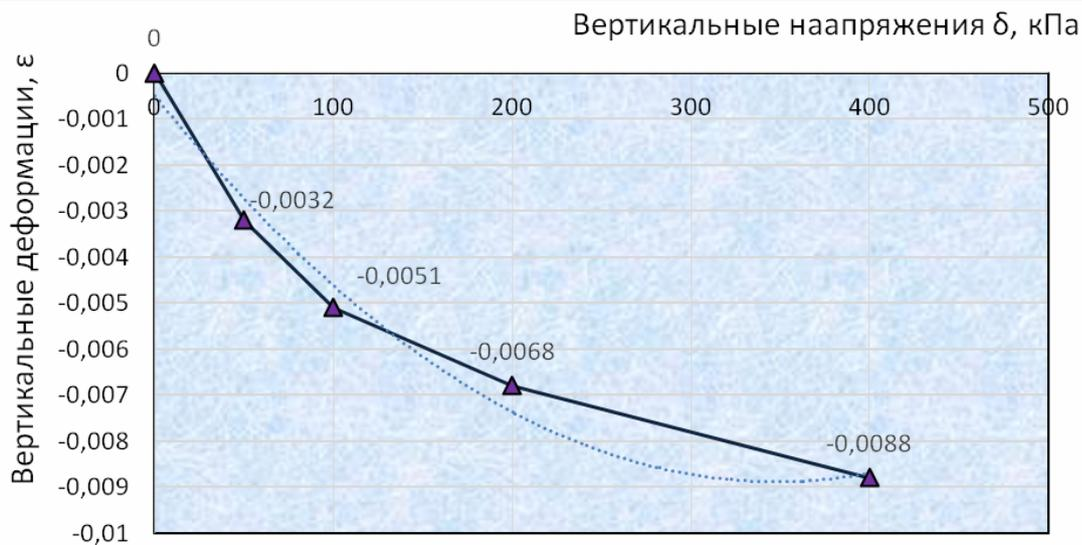
Рис. 1. Зависимость между вертикальным напряжением ( $\delta$ ) и вертикальной деформацией ( $\epsilon$ )
