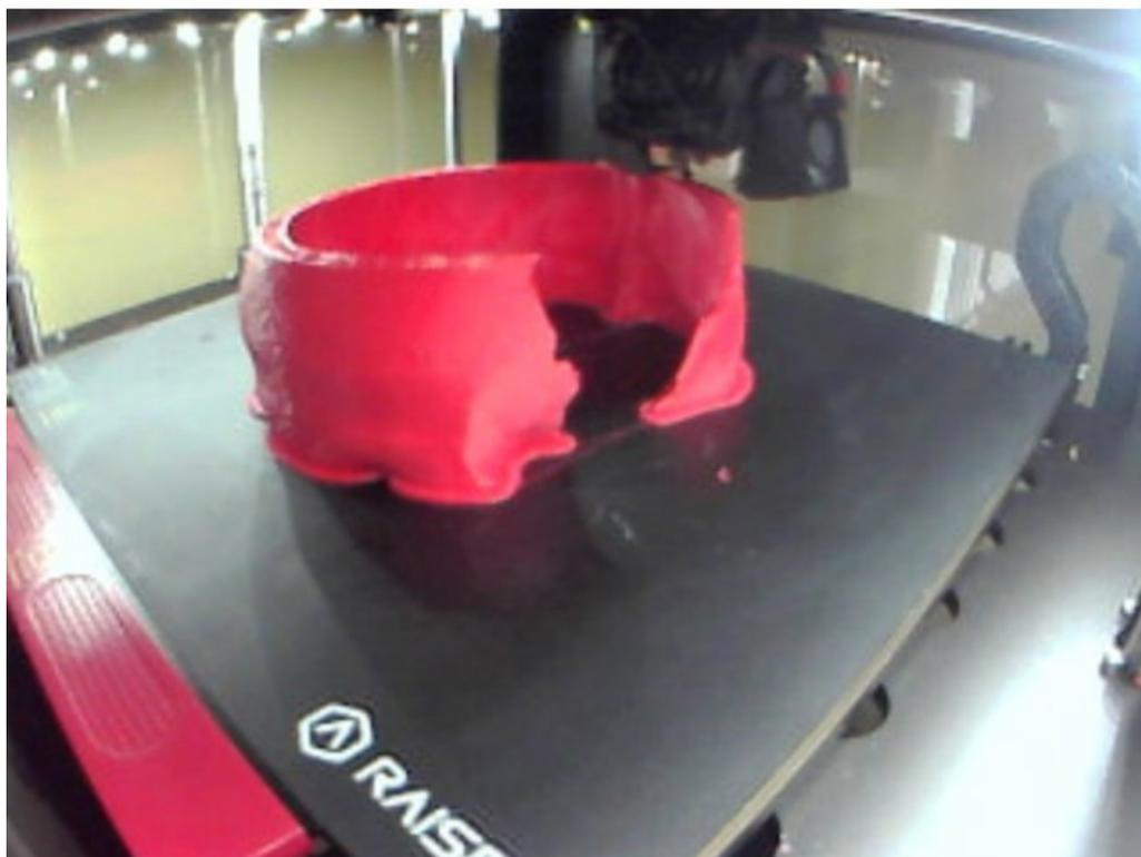
Рис. 6. 3D-печать формы для отливки импланта
