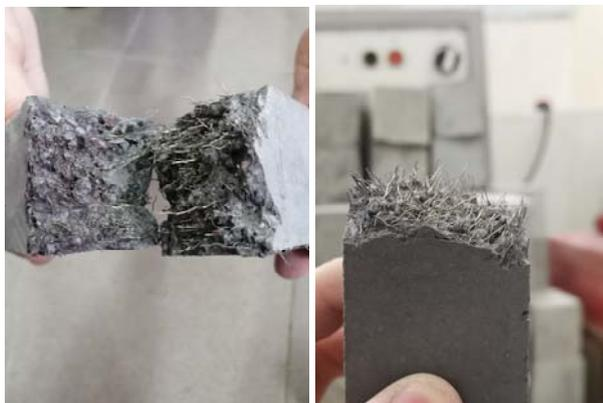
Рис. 1. Характер излома образцов после испытания на изгиб
