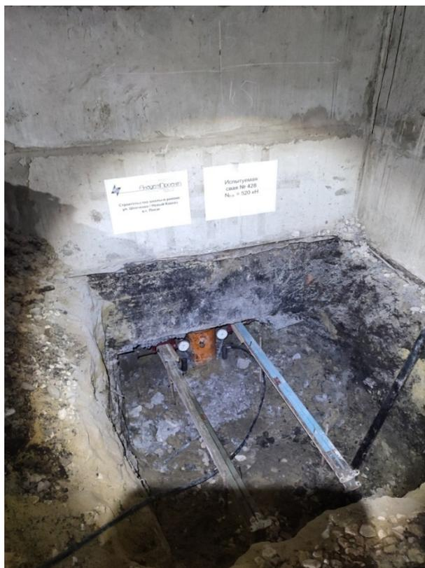
Рис. 4. Проведение статических испытаний опытной сваи.
