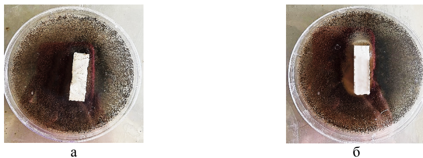
Рис. 5. Развитие гриба Aspergillus niger на питательной среде в присутствии принудительно карбонизованного цементного камня контрольного (а) и со вспученным перлитовым песком (б)
