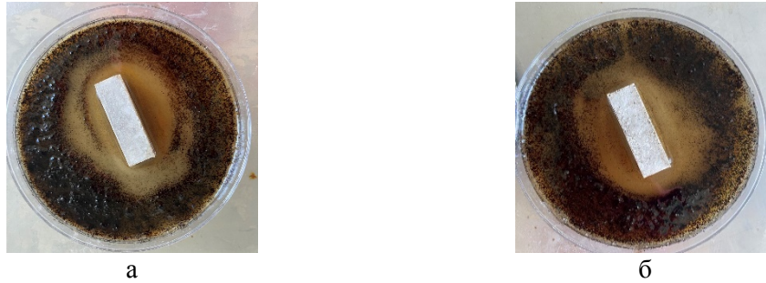
Рис. 4. Развитие гриба Aspergillus niger на питательной среде в присутствии цементного камня контрольного (а) и со вспученным перлитовым песком (б)
