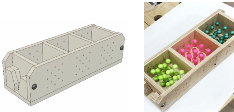
Рис. 4. Модифицированная форма для образцов-кубиков и размещение гранул пенополистирола перед заливкой гипсовой смесью
