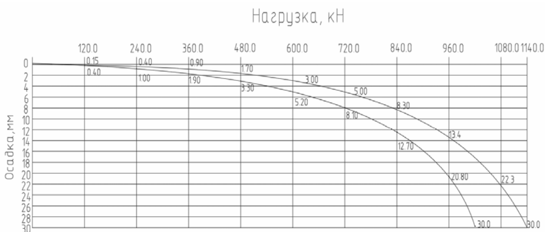
Рис. 6. Графики зависимости осадки от нагрузки свай с краевыми значениями несущей способности
