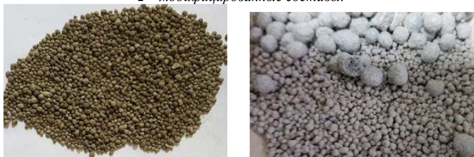
Состав № 1: до (слева) и после (справа) обжига
