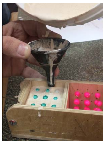
Рис. 5. Послойное заливание форм при изготовлении образцов
