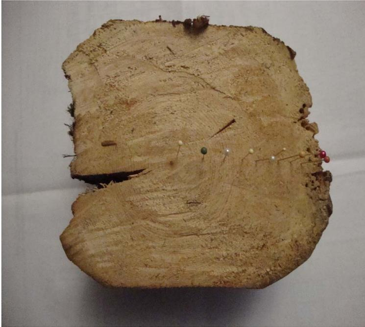
Рис. 2. Фрагмент бруса для изготовления малых стандартных образцов (размеры фрагмента бруса 16,5×19 см, количество годовых колец 125)
