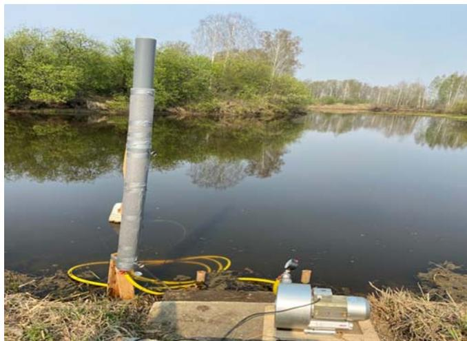
Рис. 7. Фотография модельной экспериментальной установки для получения холода с промежуточным теплообменником
