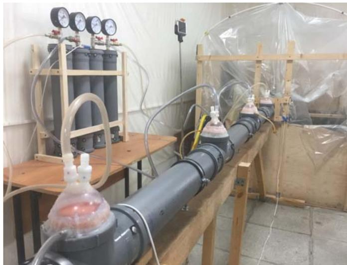
Рис. 3. Фотография экспериментального модифицированного гидротарана
