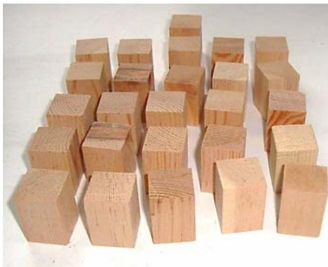
Рис. 3. Малые стандартные образцы до кратковременных испытаний на машине SHIMADZU AGX300
