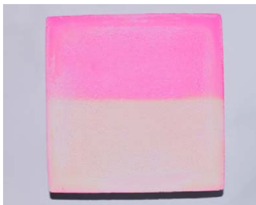
Рис. 1. Образец из цементного камня с добавкой \text{TiO}_2 , покрытого раствором родамина Б (верхняя часть находилась в темноте, нижняя часть облучалась ультрафиолетовыми лучами на протяжении 5 часов)
