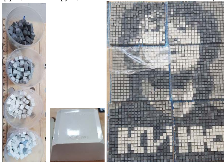
Рис. 2. Внешний вид бетонных пазлов: экспериментальные образцы 4-х оттенков (слева); поверхность белого образца (белый глянец), процесс сборки панно из отдельных блоков (карт)
