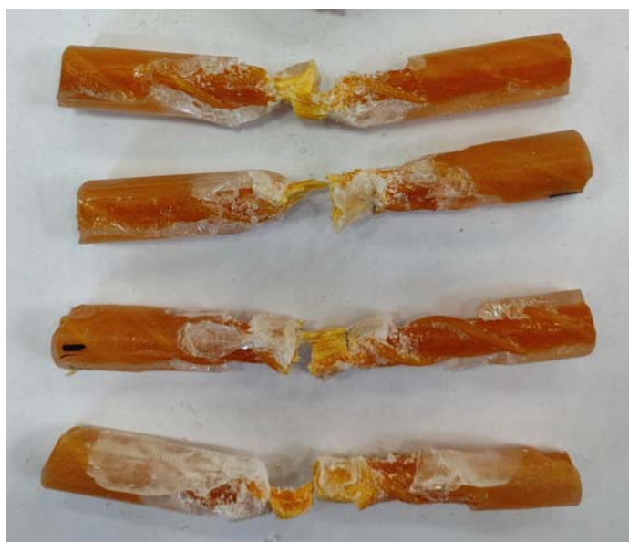
Рис. 5. Общий вид разрушения стеклопластиковых болтов
