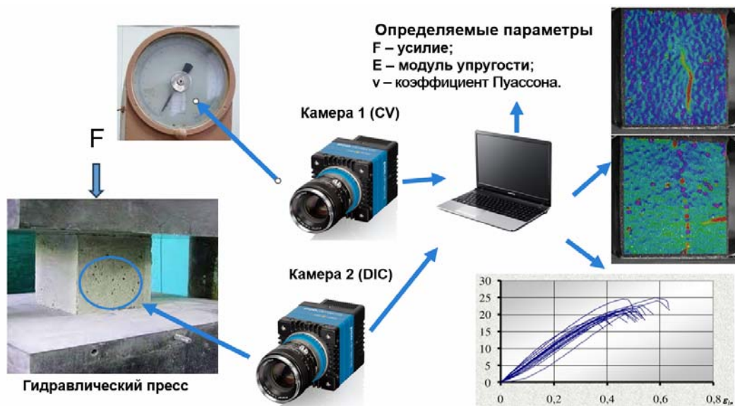
Рис. 3. Примерная схема проведения испытаний при исследовании прочностных и деформативных характеристик материалов
