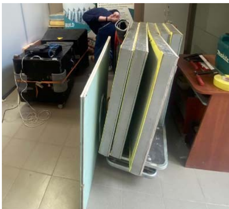
Рис. 3. Образцы с воздушным зазором перед испытанием
