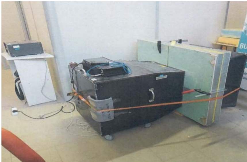
Рис. 4. Расположение образца в акустической камере
