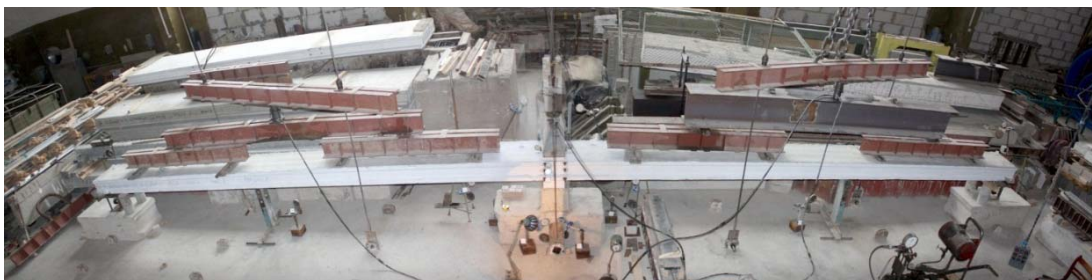
Рис. 4. Общий вид испытания многопустотных плит перекрытий с платформенным стыком на промежуточной опоре
