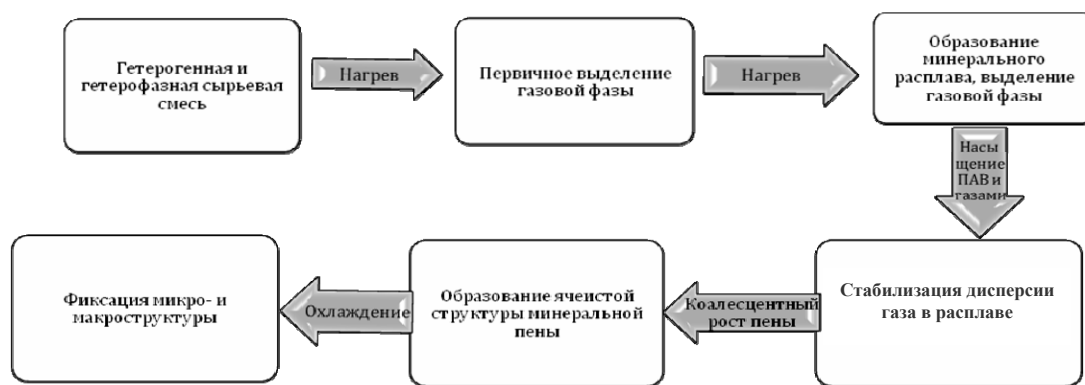
Рис. 1. Схема последовательности процессов формирования структуры вспененного стеклокристаллического материала
