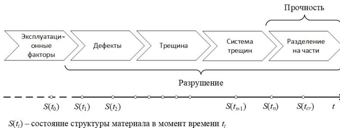
Рис. 1. Взаимосвязь понятий «разрушение» и «прочность» материалов
