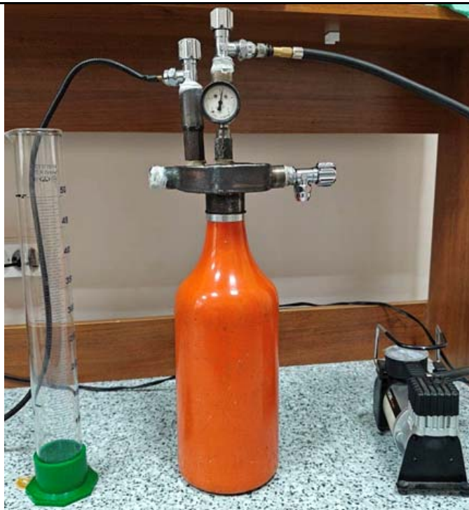
Рис. 3. Общий вид лабораторной установки для получения водовоздушной смеси методом декомпрессии насыщенного водного раствора
