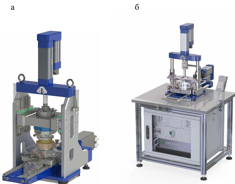
Рис. 1. Приборы для испытания материалов на сдвиг: а – статическое нагружение; б – нагружение с заданной скоростью деформации сдвига (патенты № 64310, 66389 [4, 5])
