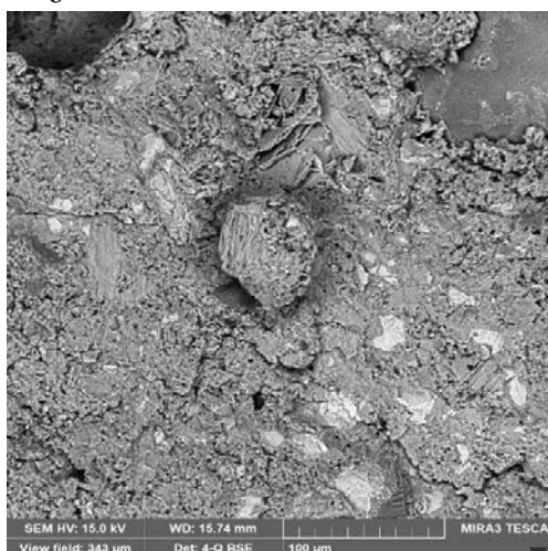
Рис. 1. Биодобавка для бетонов (а) и фото разлома бетона, получено с применением сканирующей электронной микроскопии (б)
