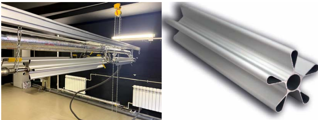
Рис. 1. Общий вид лабораторной установки систем лучистого отопления с промежуточным теплоносителем (слева) и излучающего профиля Flower 225 (справа)
