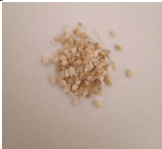
Рис. 1. Биодобавка для бетонов (а) и фото разлома бетона, получено с применением сканирующей электронной микроскопии (б)
