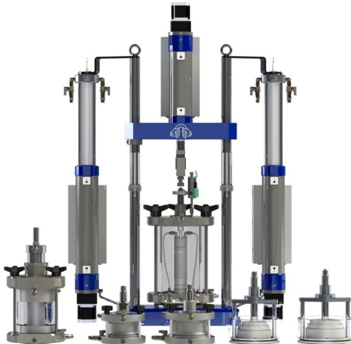
Рис. 2. Прибор трехосного сжатия (патенты № 85167, 64648 [6, 7])
