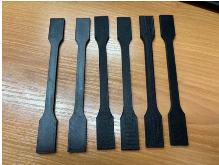
Рис. 2. Опытные образцы, изготовленные на 3D-принтере
