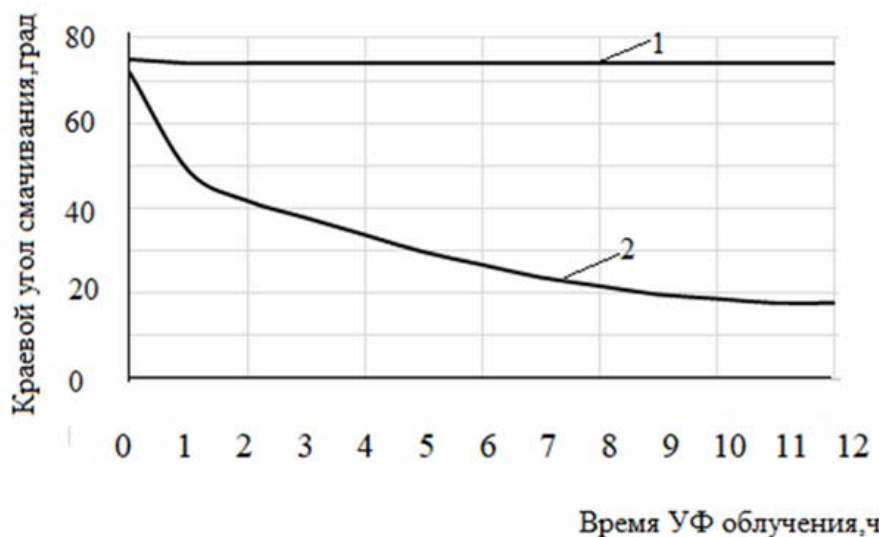
Рис. 2. Изменение значения краевого угла смачивания от времени УФ-облучения образца покрытия на основе разрабатываемого состава:
