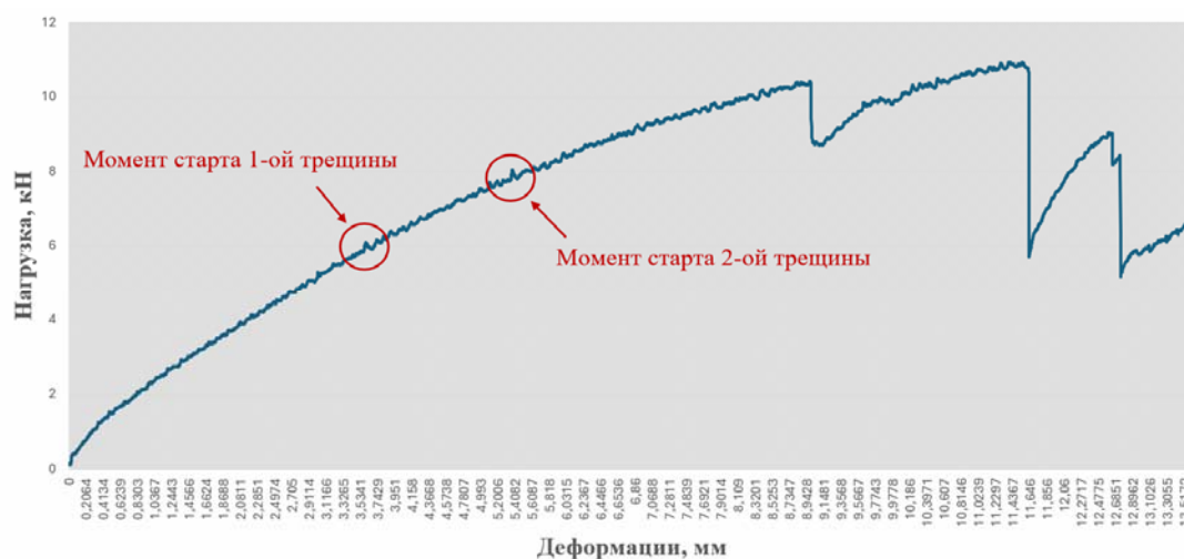
Рис. 2. Диаграмма «нагрузка – деформации» образца К4.3
