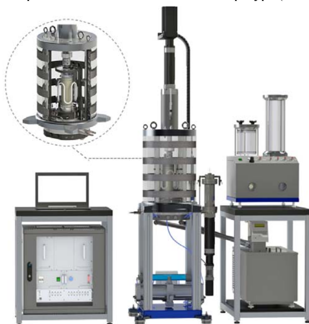
Рис. 4. Прибор трехосного сжатия для испытаний пластично-мерзлых грунтов ( www.npp-geotek.ru )
