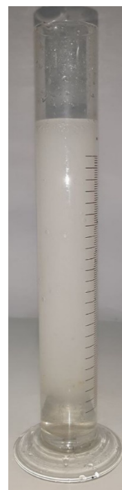
Рис. 3. Общий вид водовоздушной смеси, сформированной при величине избыточного давления \Delta P = 0,3 МПа
