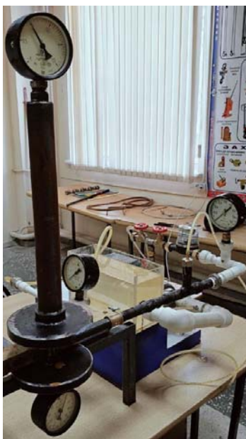
Рис. 2. Общий вид полупромышленной установки вихревого сатуратора
