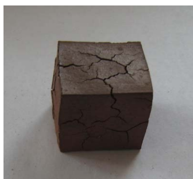
Рис. 4. Трещины на образце из Блиновской глины при температуре обжига 1050°C
