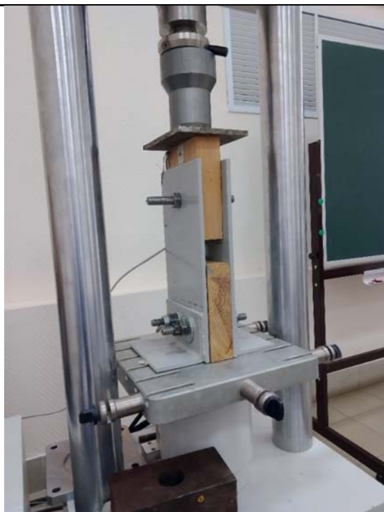
Рис. 3. Испытания образцов с применением шайб с внутренней резьбой
