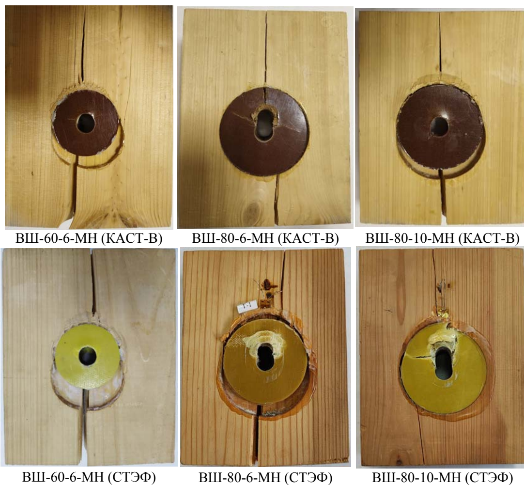
Рис. 5. Общий вид разрушения образцов
