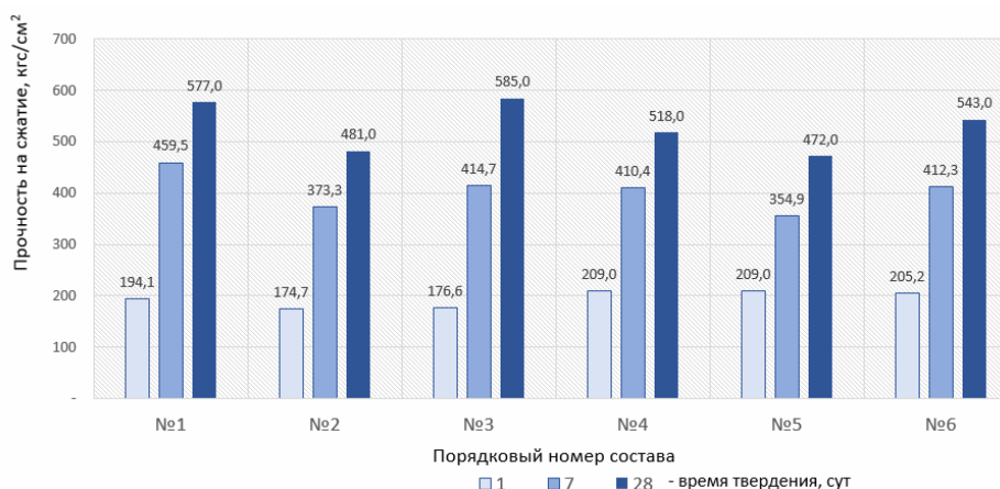
Рис. 5. Влияние вида наполнителя на прочность матрицы (нумерация по табл. 3)
