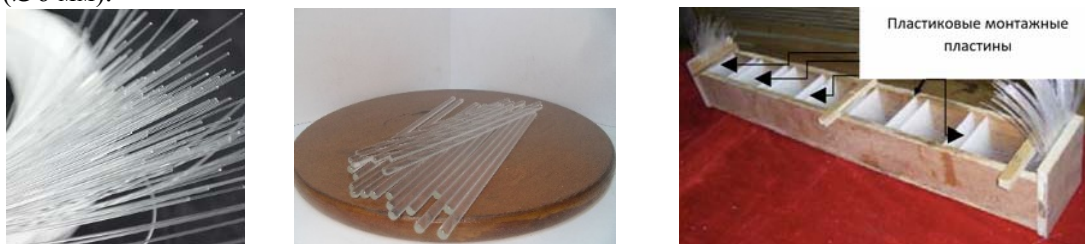
Рис. 2. Общий вид светового волокна и процесс укладки перед бетонированием
