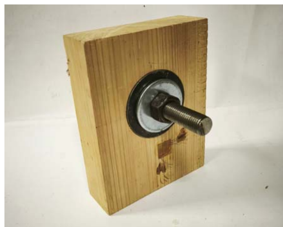
Рис. 2. Соединение на шайбах с внутренней резьбой в сборе
