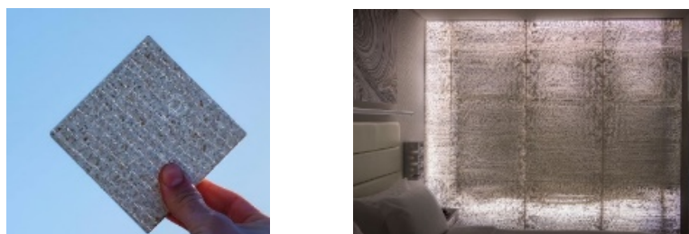
Рис. 1. Образец материала и стена из светопрозрачного метабетона [3]
