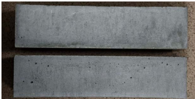
Рис.3. Образец бетона, модифицированного ПГ-5 (верхний), в сравнении с контрольным, не содержащим указанной добавки (нижний)
