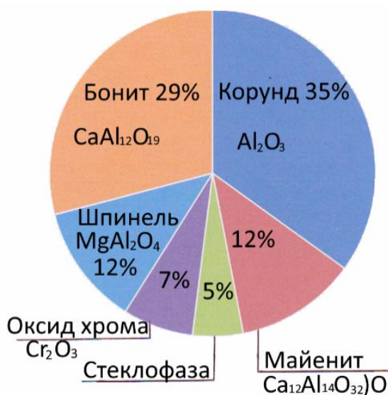
Рис. 2. Минералогический состав шлака от выплавки безуглеродистого феррохрома
