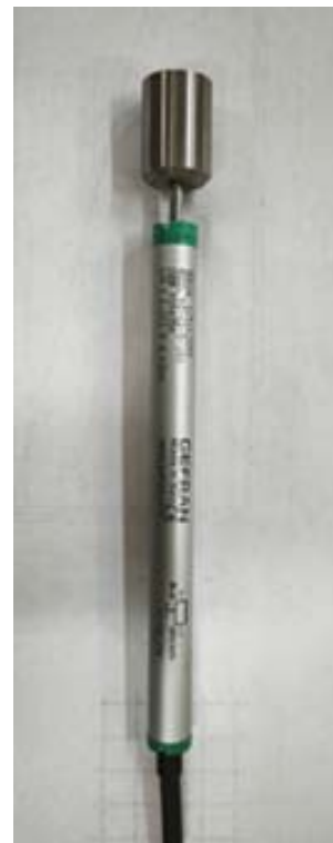
Рис. 4. Блок электронно-преобразующий ГТ 6.0.31 и устройство управления давлением ГТ 2.0.20 (а); датчик линейных перемещений PZ-12-S-100 (б)
