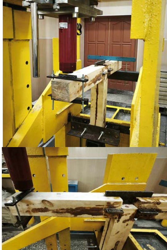
Рис. 5. Общий вид узлового соединения в испытательном прессе
