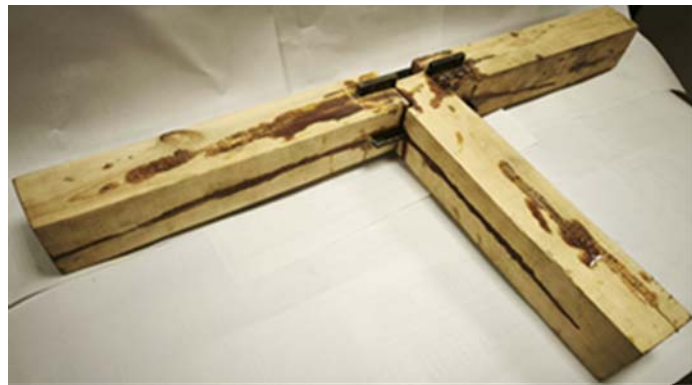
Рис. 3. Общий вид деревянных элементов до склеивания (а). Общий вид узлового соединения после сборки (б)
