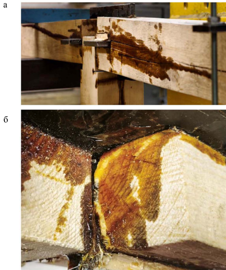
Рис. 7. Разрушение узлового соединения:
