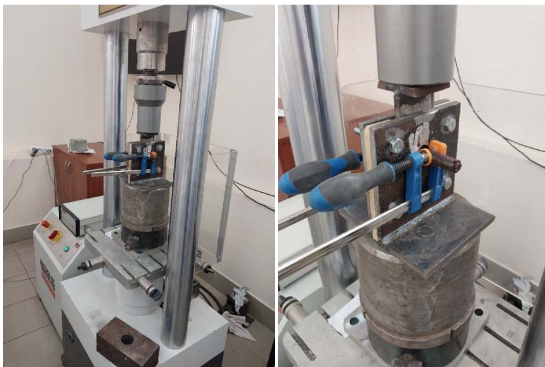
Рис. 2. Испытание образцов на гидравлическом прессе П-500
