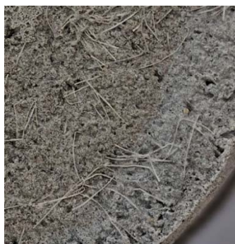
Рис.3. Мезоструктура дисперсно-армированного цементного композита (поле изображения 10 мм) (состав № 3)
