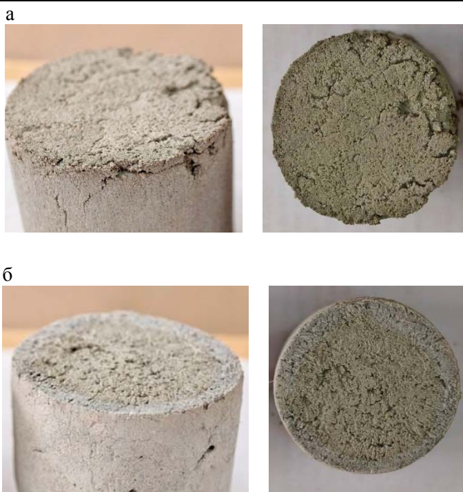
Рис. 2. Образцы затвердевшего экструдированного материала: а – контрольный состав (№ 0 по табл.1); б – состав с добавлением САП и целлюлозного волокна (№ 3 по табл.1)
