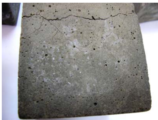
Рис. 2. Характер разрушения поверхности контрольного образца
