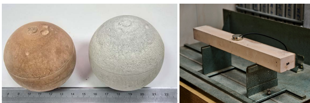
Рис. 4. Контрольные образцы: красный цвет – из разработанного каустического доломита; белый – из магниального цемента (промышленный эталон)
