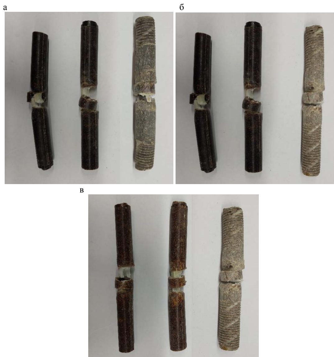
Рис. 4. Общий вид разрушения образцов с различным процентом армирования: а – 15 %; б – 25 %; в – 35 %
