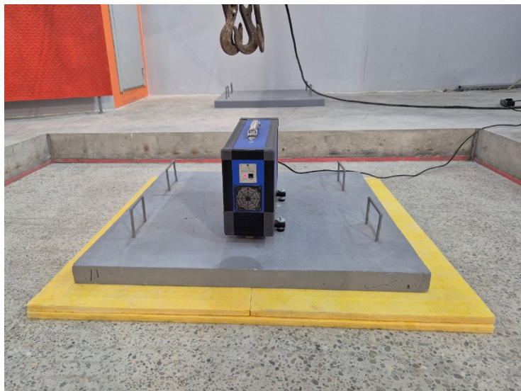
Рис. 1. Стандартная ударная машина, размещенная на исследуемой конструкции пола при проведении измерения
