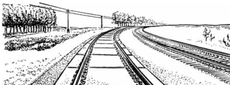
Рис. 15. Путь на блочном железобетонном основании из плит
