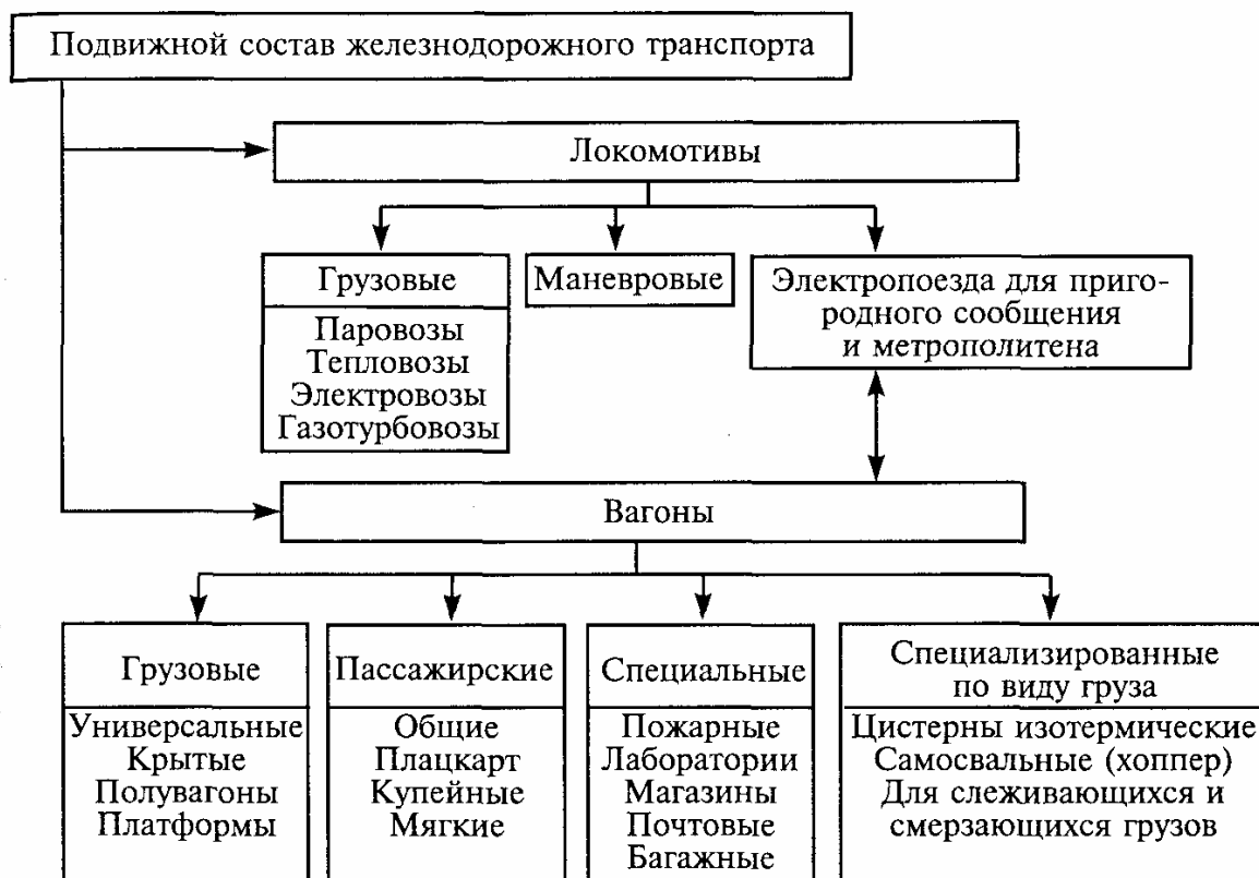
Рис. 9. Классификация подвижного состава железнодорожного транспорта
