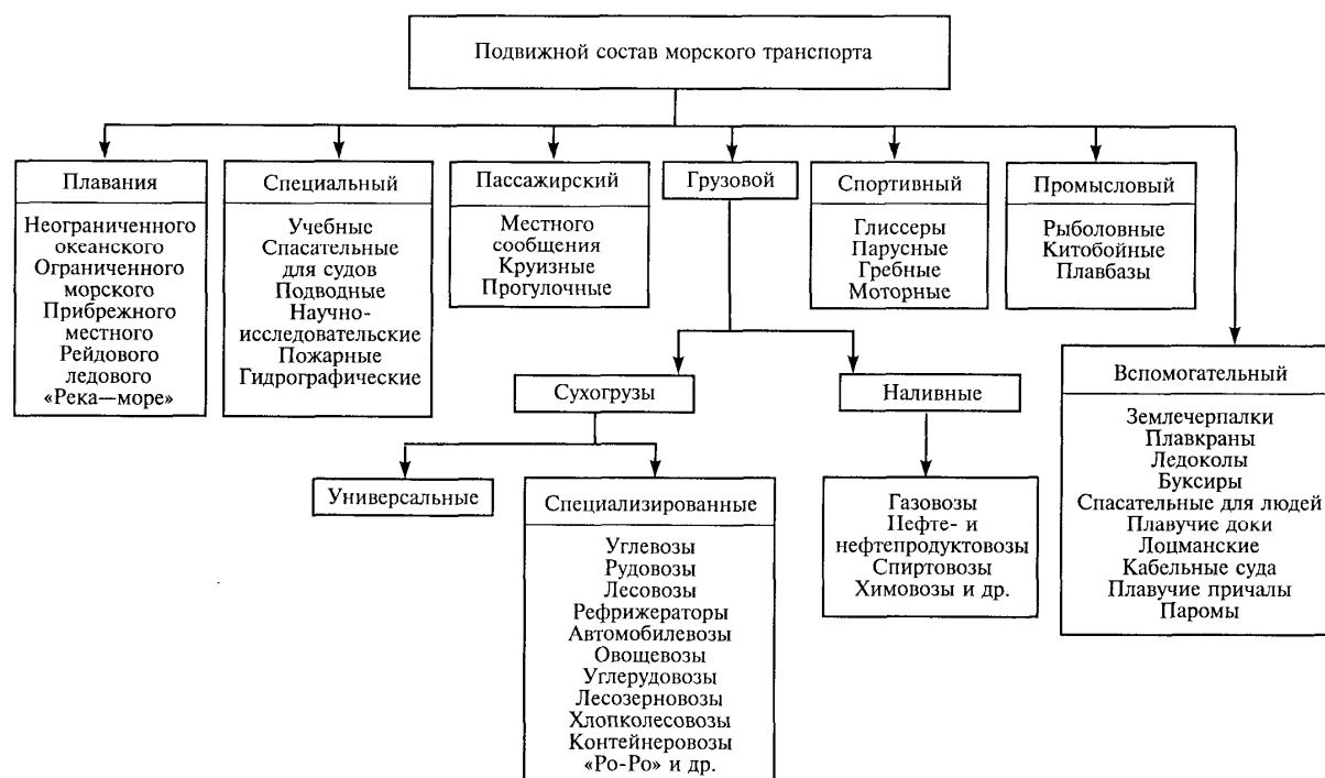
Рис. 2. Классификация подвижного состава морского транспорта
