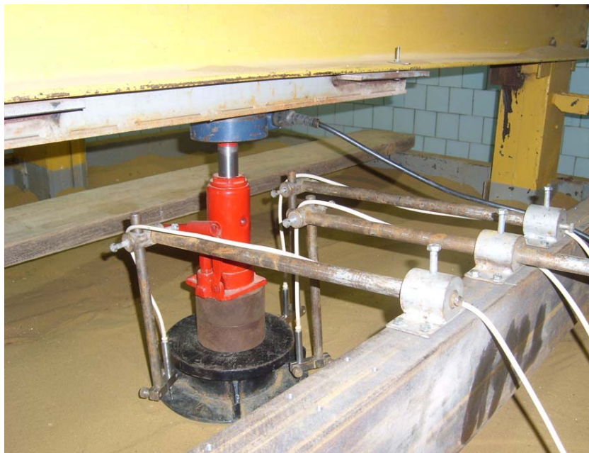
Рис. 4.1. Испытания круглым жестким штампом песчаного основания
