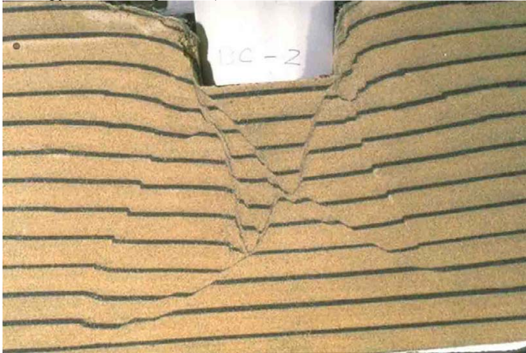
Рис. 2.3. Линии сдвига в песке после испытания в условиях плоской деформации модели ленточного фундамента
