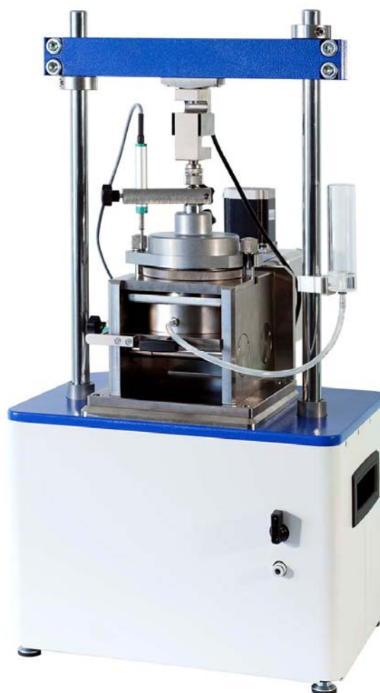
Рис. 3.5. Устройство одноплоскостного среза (производство ООО «НПП Геотек» http://www.npp-geotek.ru/ )
