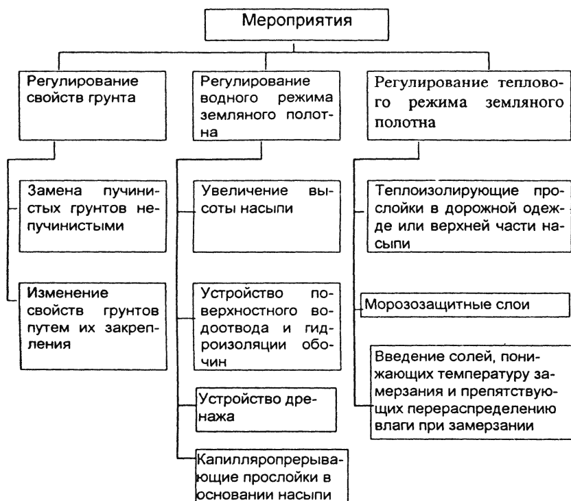
Рис. 13. Мероприятия по устранению причин пучинообразования, применяемые при реконструкции дорог I
