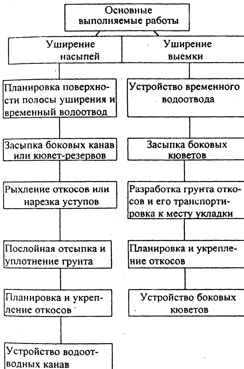
Рис.9. Последовательность работ при уширении земляного полотна
