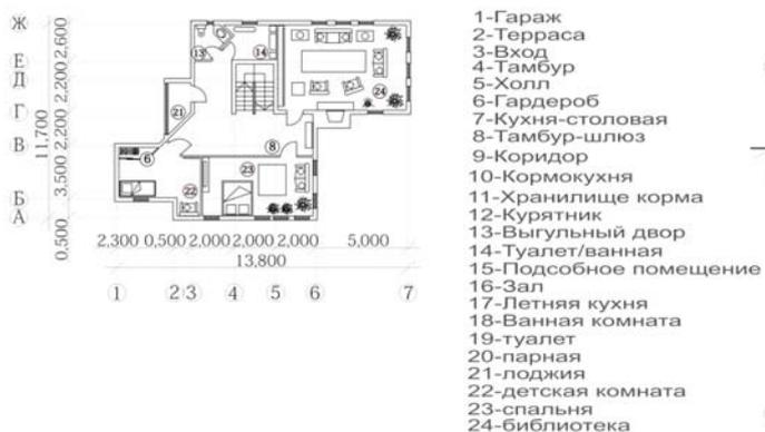
Рис 1. Пример выполнения плана жилого дома фермера
