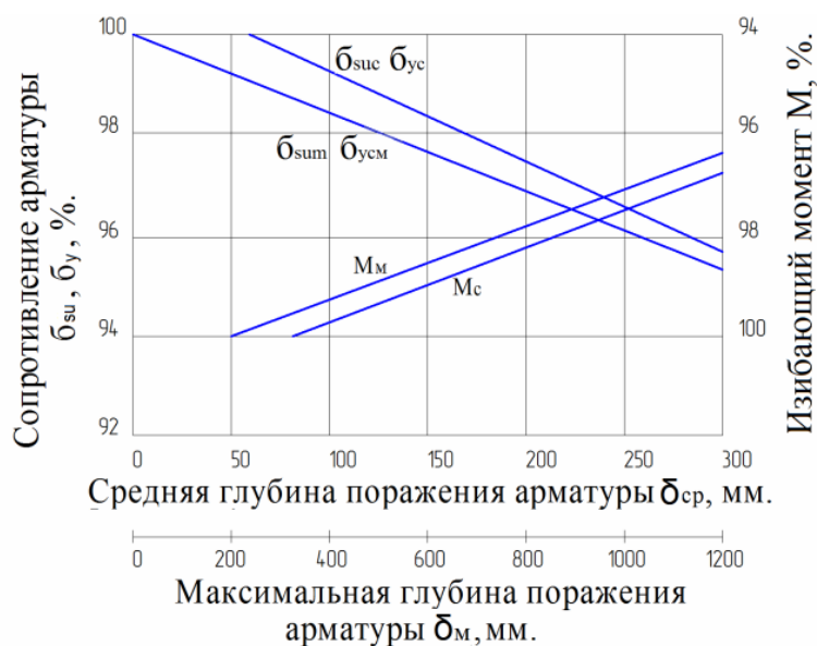
Рис. 7.15. Зависимости изменения величины несущей способности железобетонных балок и физико-механических характеристик арматуры класса А-III \varnothing 14 мм от глубины коррозионного поражения арматуры: \sigma_{su} и \sigma_y – соответственно среднее временное сопротивление и физический предел текучести арматуры; M_c – изгибающий момент для постоянного нагружения; M_m – изгибающий момент для переменной нагрузки; индексы C и M – соответственно постоянное и переменное нагружение; \delta_{ср} и \delta_m – соответственно средняя и максимальная глубина коррозионного поражения арматуры
