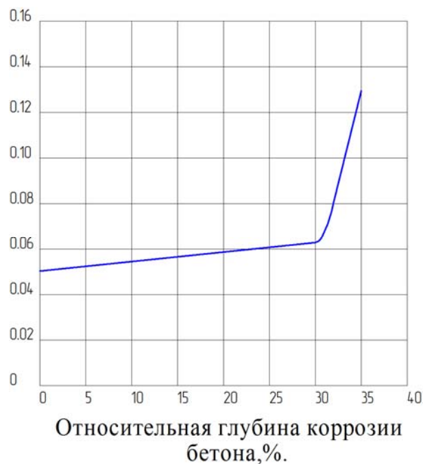
Рис.6.12. а – влияние коррозии арматуры на ширину раскрытия нормальных трещин; б – влияние относительной глубины проникновения фронта коррозии бетона на ширину раскрытия нормальных трещин
