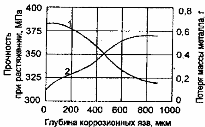
Рис. 7.2. Зависимости прочности при растяжении арматуры и потери массы металла от глубины коррозионных язв: 1 – прочность при растяжении; 2 – потеря массы металла
