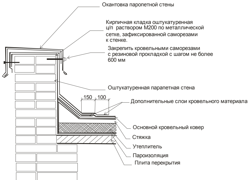
Рис.15. Устройство парапета в кирпичной стене
