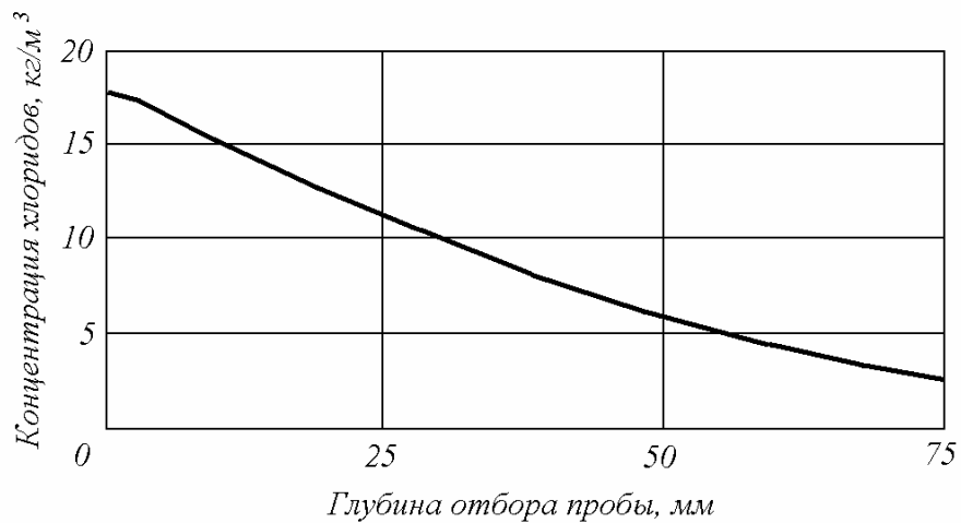
Рис. 1.19. Содержание хлоридов в железобетонном (В/Ц=0,40) покрытии паркинга после 40 лет эксплуатации
