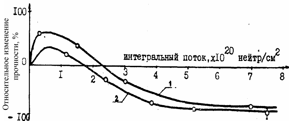
Рис. 1.50. Изменение прочности при сжатии кварцесодержащих бетона и раствора при облучении: 1 – бетон, 2 – раствор
