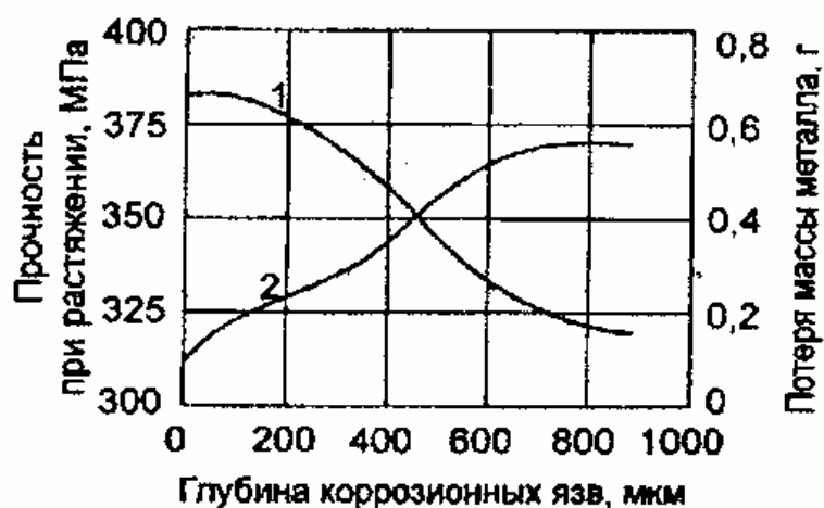
Рис. 1.12 Зависимости прочности при растяжении арматуры и потери массы металла от глубины коррозионных язв: 1 – прочность при растяжении; 2 – потеря массы металла
