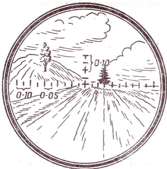
Рис. 21. Измерение углов биноклем
