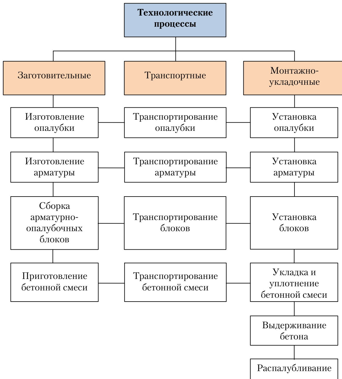
Рис. 10.1. Схема технологического процесса возведения монолитных железобетонных конструкций
