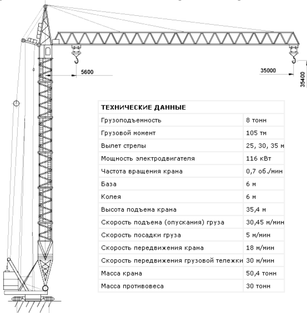
Рис. 5.1. Башенный кран КБ-403Б.4 с техническими характеристиками
