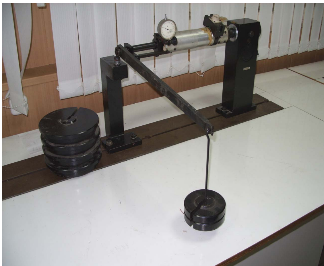
Рис. 4.8. Фотография установки для испытания на кручение
