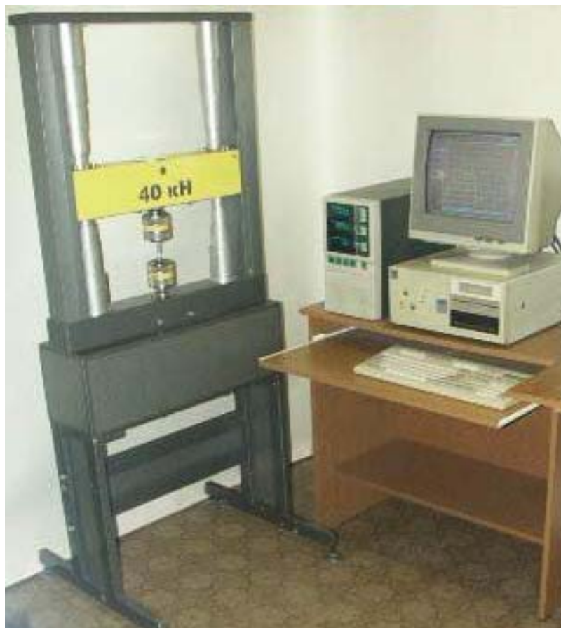
Рис. 1.4. Общий вид машины КСИМ-40 для испытаний на растяжение и сжатие
