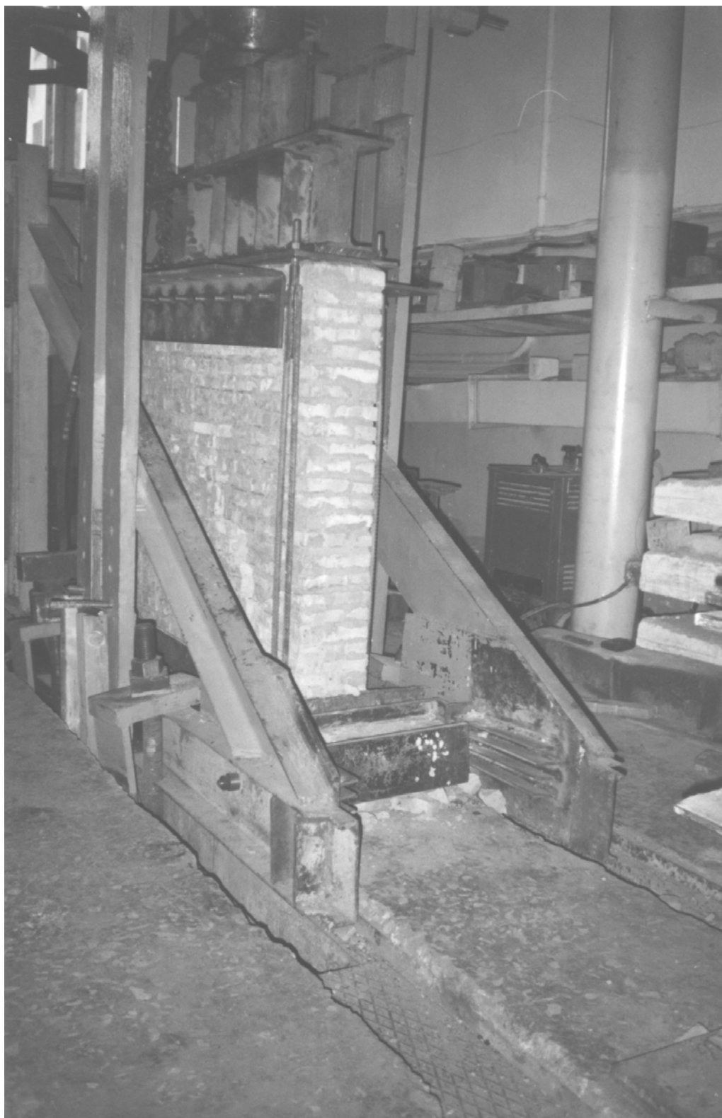
Рис. 5.13. Общий вид силовой установки при испытании стен
