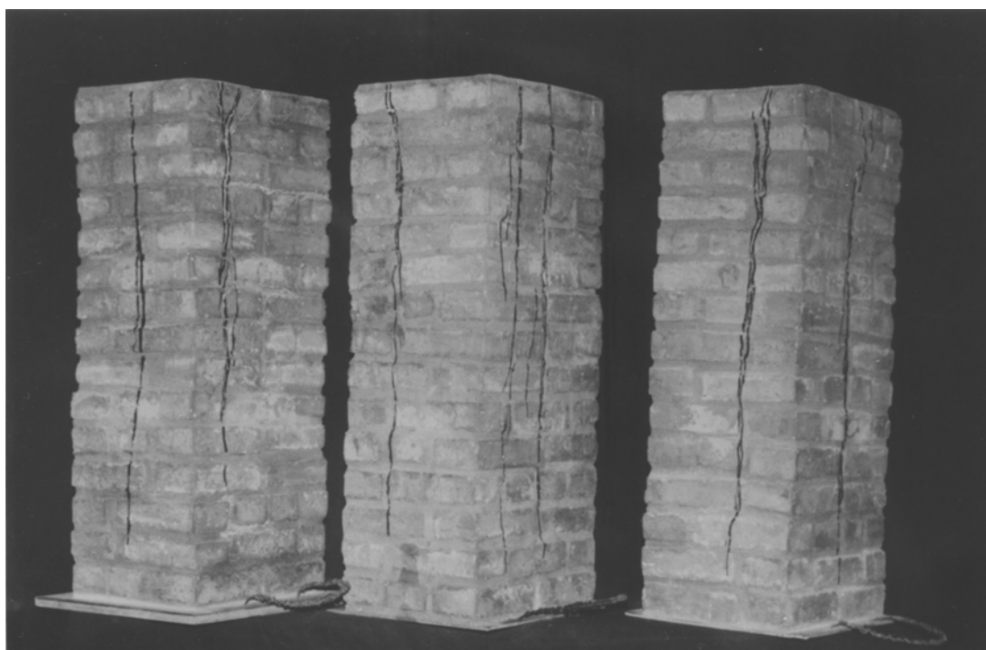
Рис. 5.11. Общий вид разрушения стандартных столбов-призм, выполненных по цепной системе перевязки (а) и по трехрядной системе проф. Л.И. Онищика (б)
