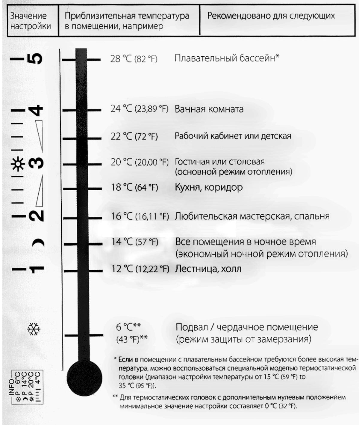
Рис. 20. Настройка термостатической головки
