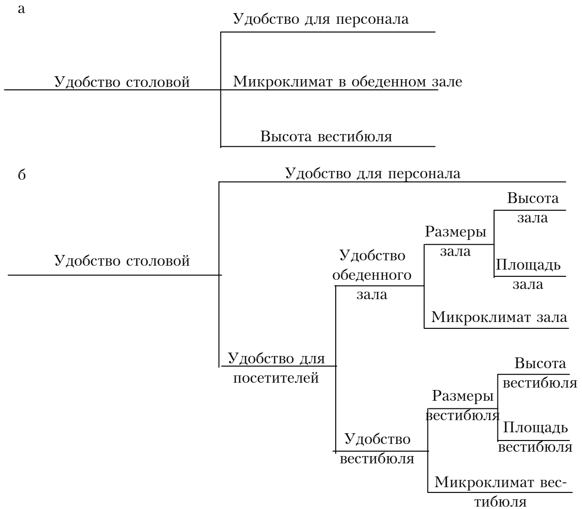
Рис. 6. Построение дерева свойств: а – неправильно; б – правильно
