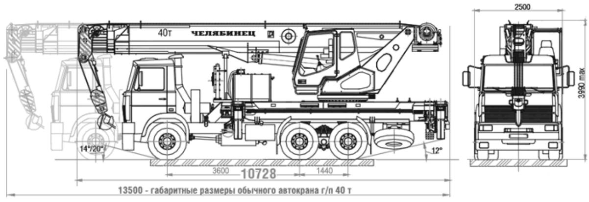
Автокран КС-65711-27 «ЧЕЛЯБИНЕЦ» – это модель из обновленной серии автомобильных кранов 2010 года грузоподъемностью 40 т на шасси КАМАЗ-6520 (6×4).
