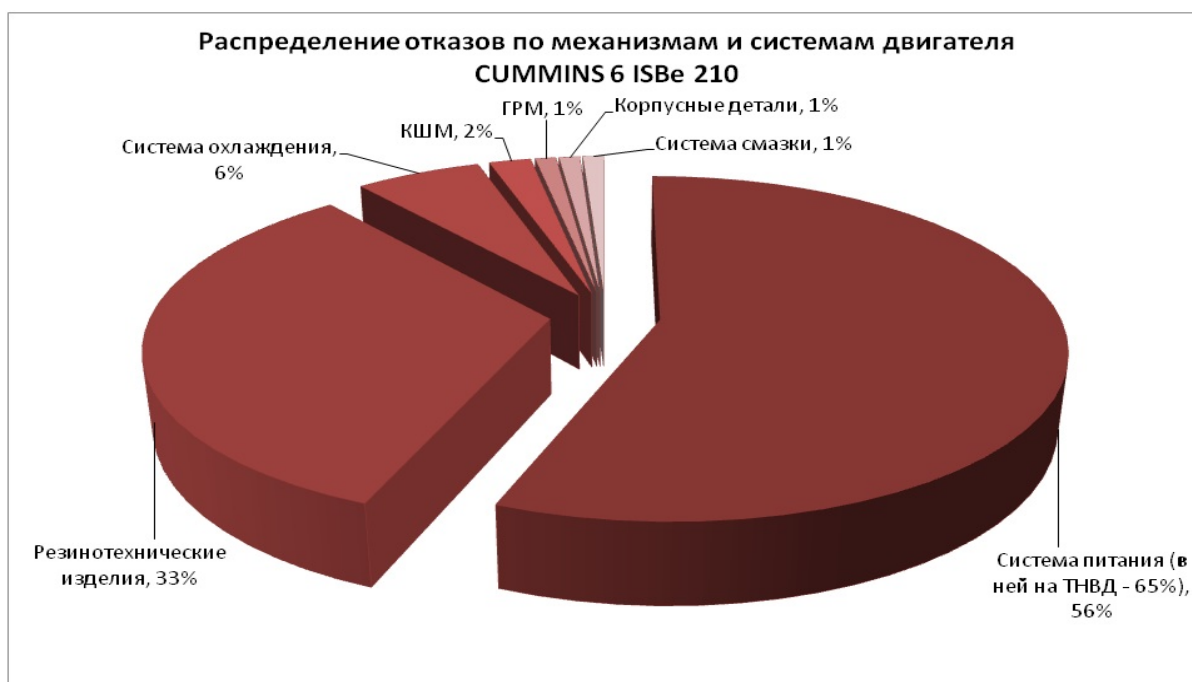
Рисунок 2.3 – Распределение отказов по механизмам и системам двигателя КАМАЗ
