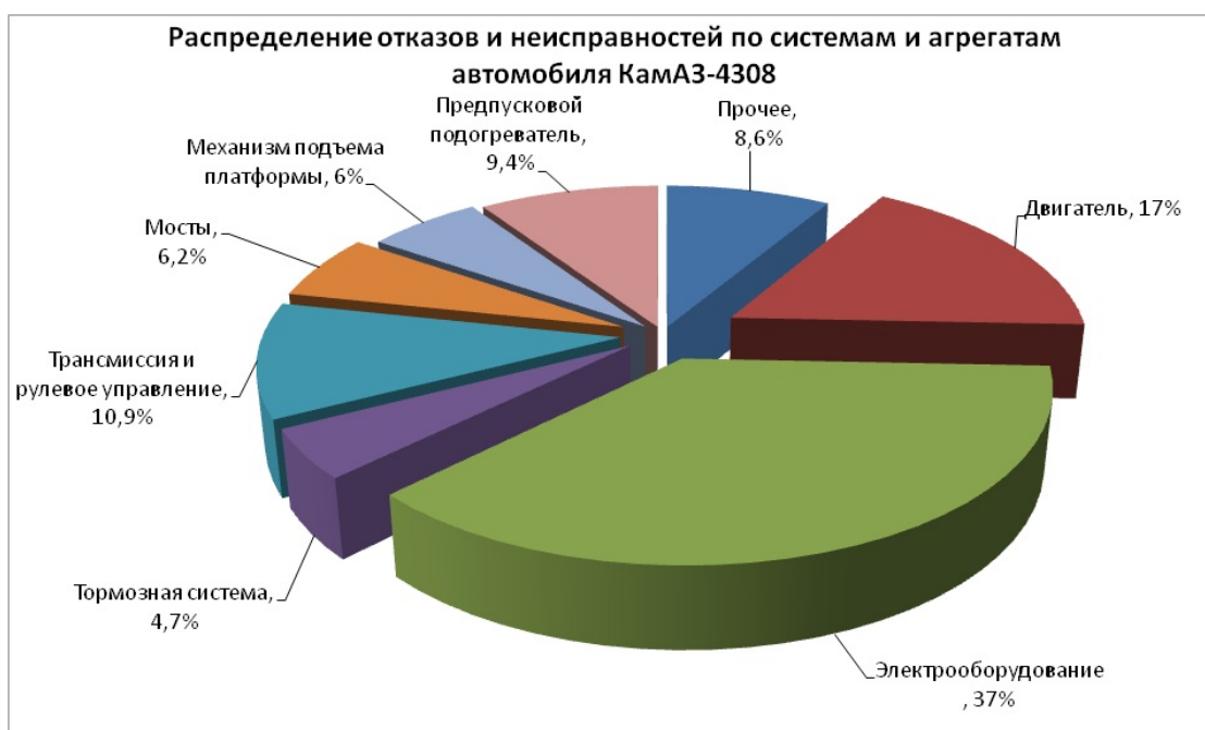
Рисунок 2.2 – Распределение отказов и неисправностей по системам и агрегатам автомобиля КАМАЗ-4308
